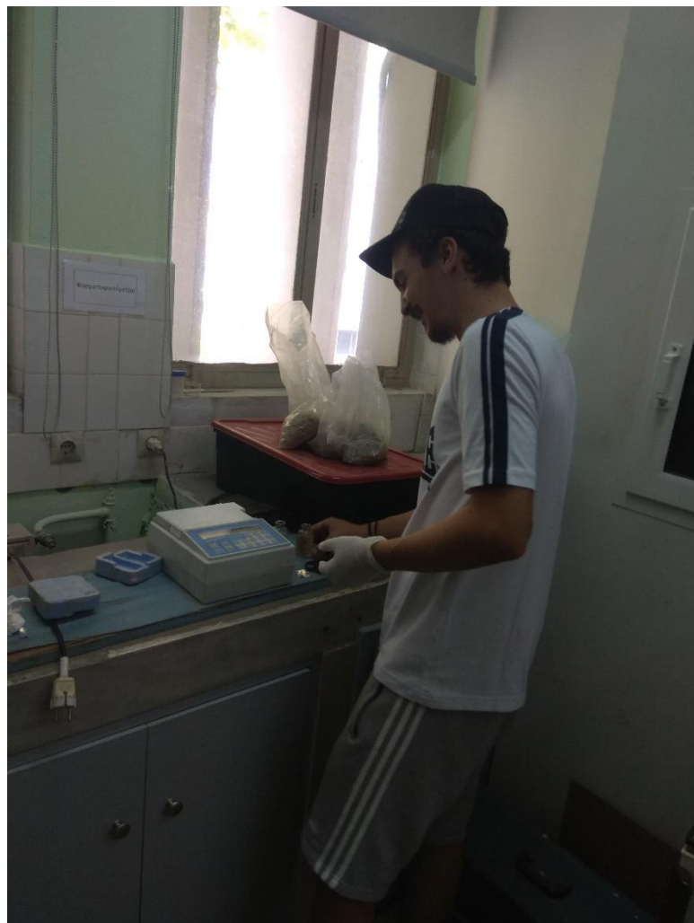
Εικόνα 5-6 : Μέτρηση συγκέντρωσης ποσότητας νιτρικών στο εργαστήριο
