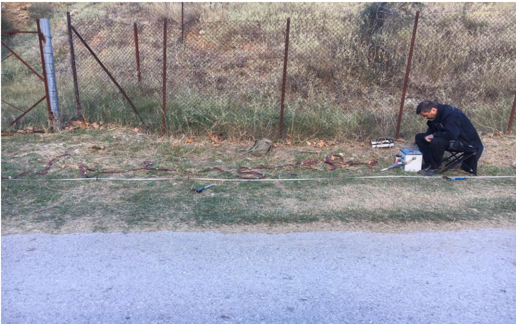
Σχήμα 12: Μετρήσεις ειδικής ηλεκτρικής αντίστασης.
