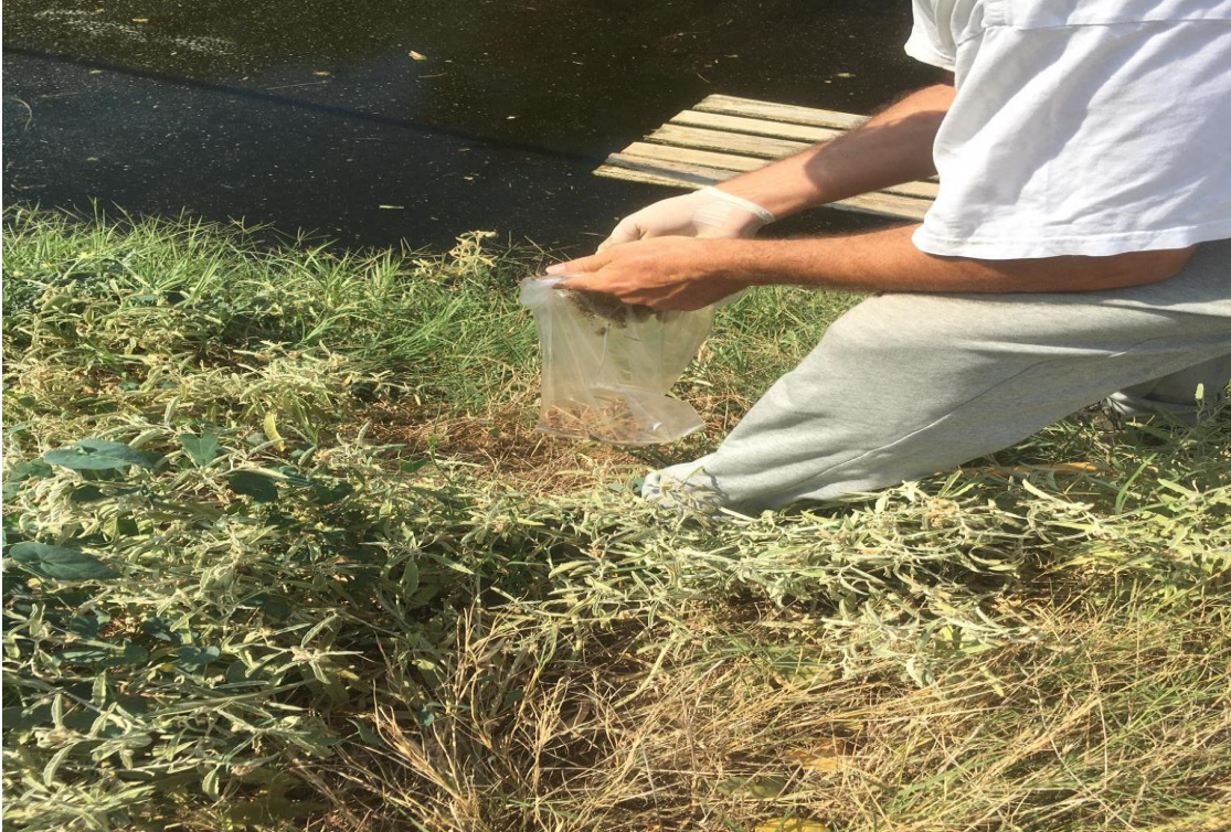
Σχήμα 11: Λήψη εδαφικών δειγμάτων εντός της λεκάνης στην επαφή με τα διασταλλάζοντα. ( Δείγματα Νο1-Νο4 )
