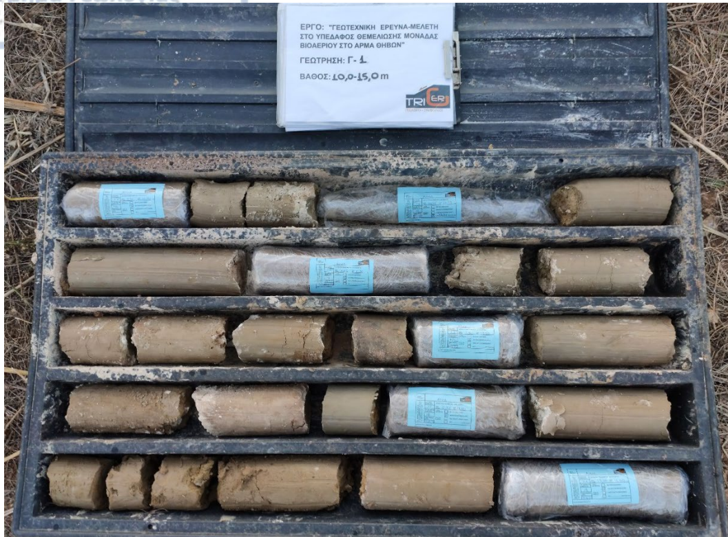
Εικόνα 12: Δειματοληπτική Γεώτρηση Γ-1 για Βάθος 10,00-15,00m.
