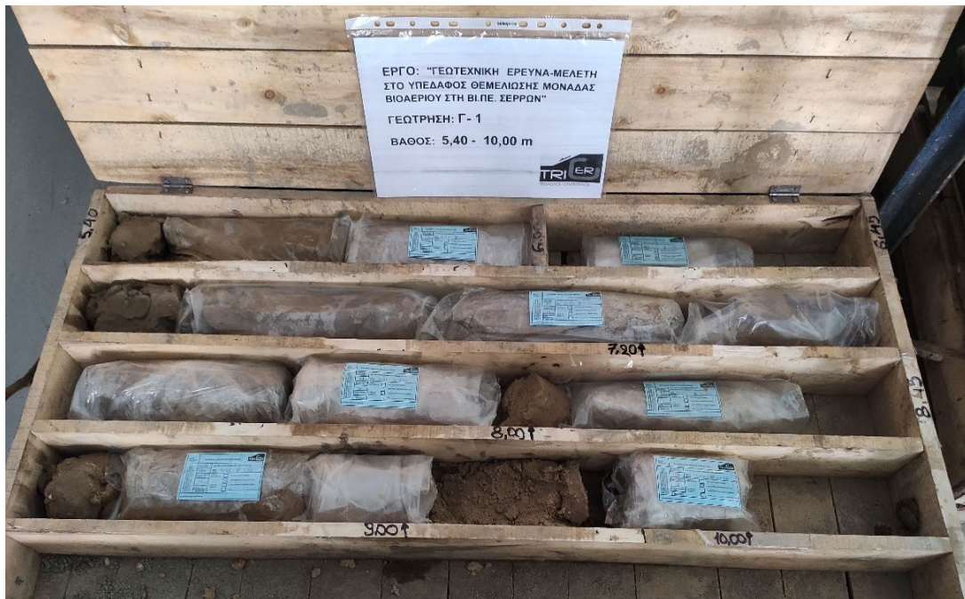
Εικόνα 22:Δειγματοληπτική Γεώτρηση Γ-1 για Βάθος 5,40-10,00m.
