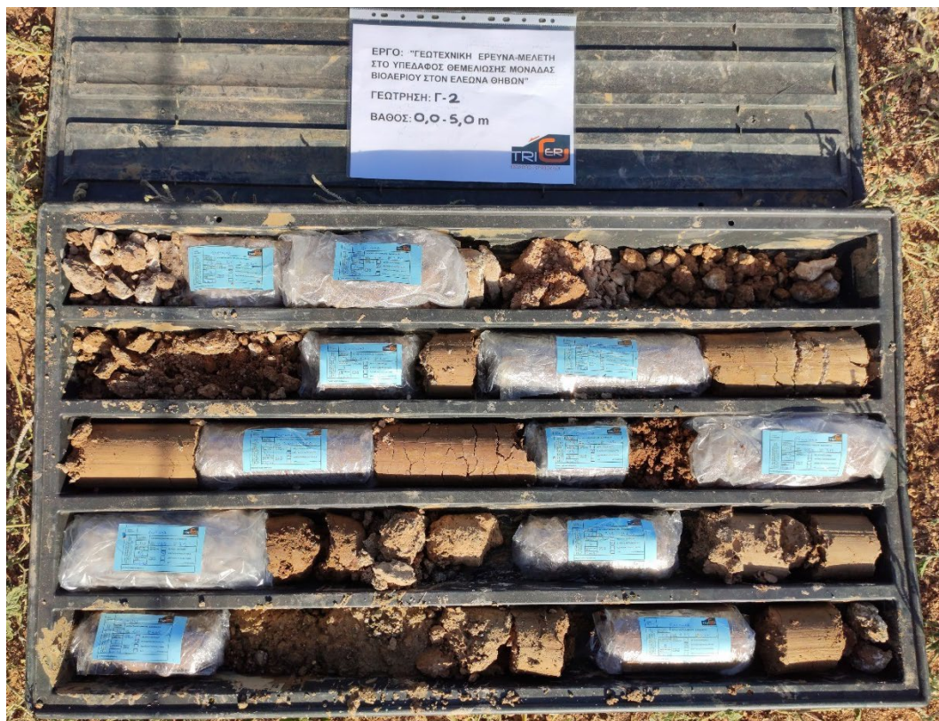
Εικόνα 16: Δειγματοληπτική γεώτρηση Γ-2 για το βάθος 0,00-5,00
