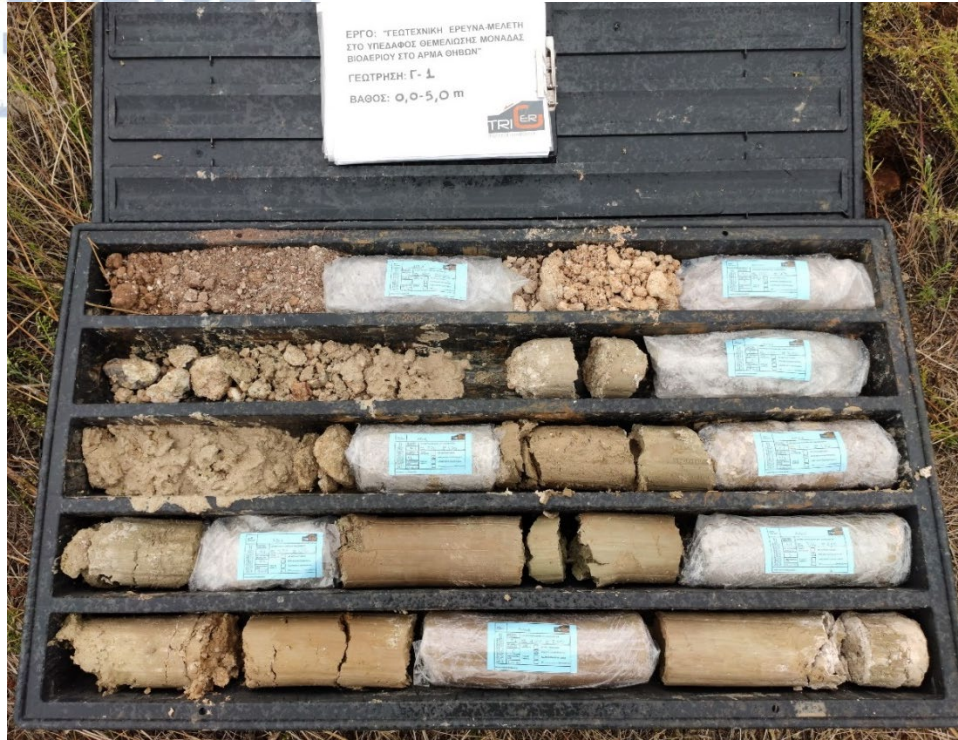
Εικόνα 10: Δειγματοληπτική Γεώτρηση Γ-1 για Βάθος 0,00-5,00m.
