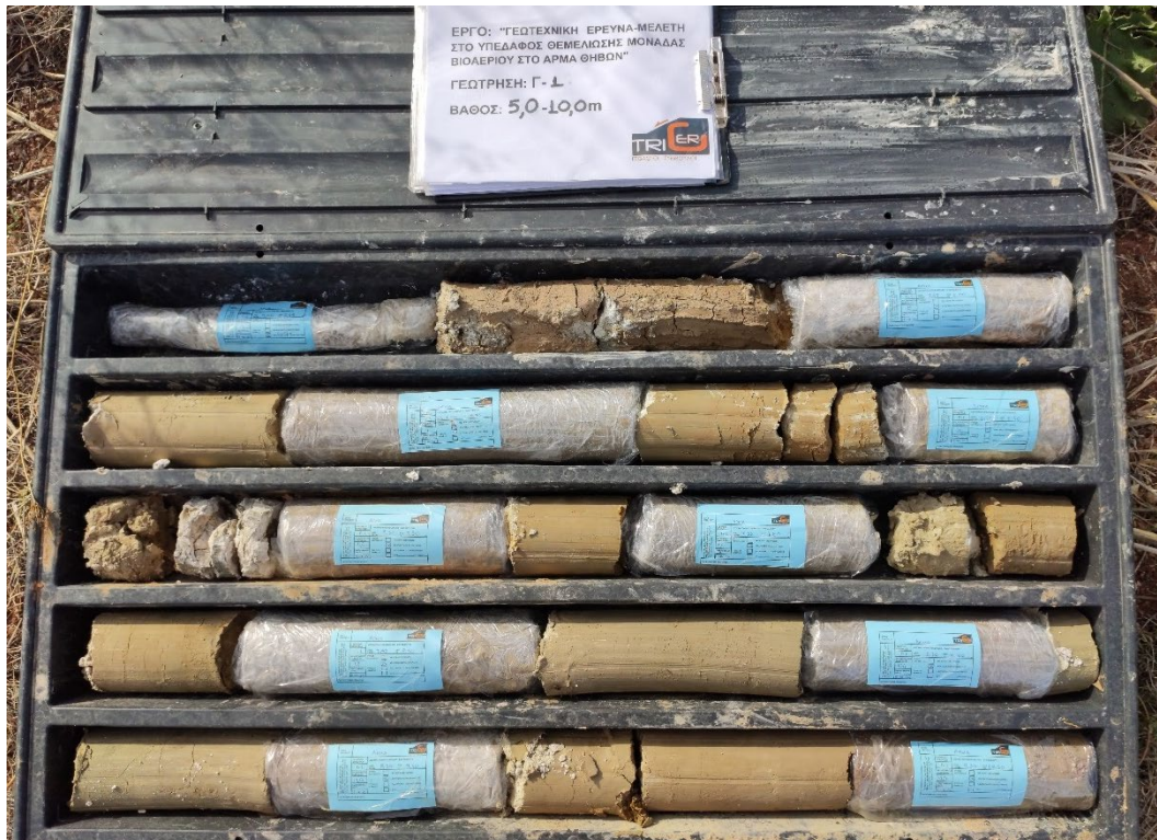
Εικόνα 11: Δειγματοληπτική Γεώτρηση Γ-1 για Βάθος 5,00-10,00m.
