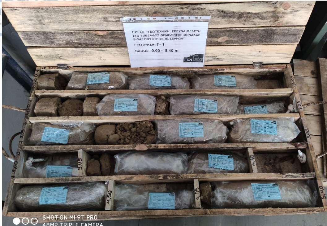
Εικόνα 21:Δειγματοληπτική Γεώτρηση Γ-1 για Βάθος 0,00-5,40m.
