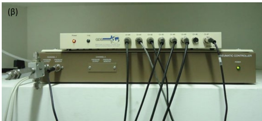
Εικόνα 53: (α) Ηλεκτρονικός ελεγκτής υψηλής ακρίβειας νερού "Standard Pressure/Volume Controller (STDDPC) v2", (β) Πνευματικός ελεγκτής υψηλής ακρίβειας αέρα " Pneumatic Pressure Controller (GDSPPC)". (Βλάχος, 2015)
