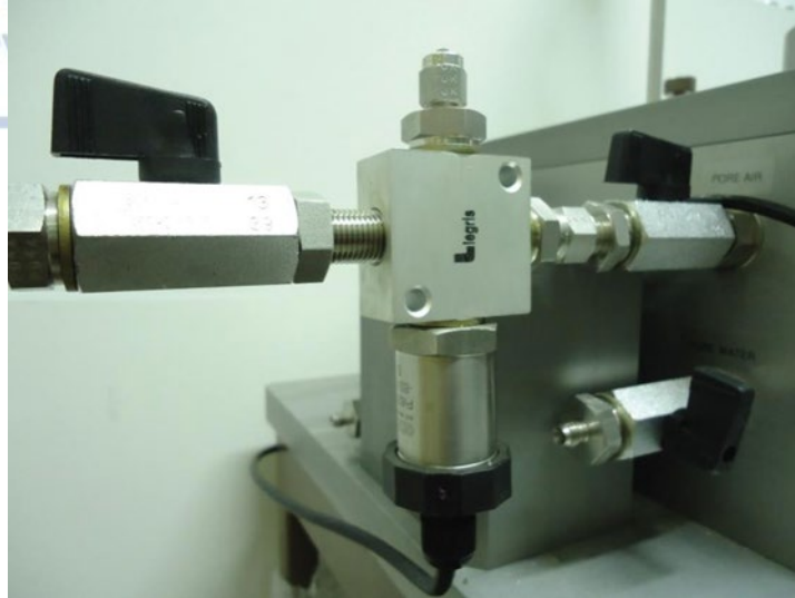
Εικόνα 55: Ηλεκτρονικός μετατροπέας υψηλής ακρίβειας (transducer) για τον έλεγχο των μετρήσεων μέσα στο θάλαμο. (Βλάχος, 2015)
