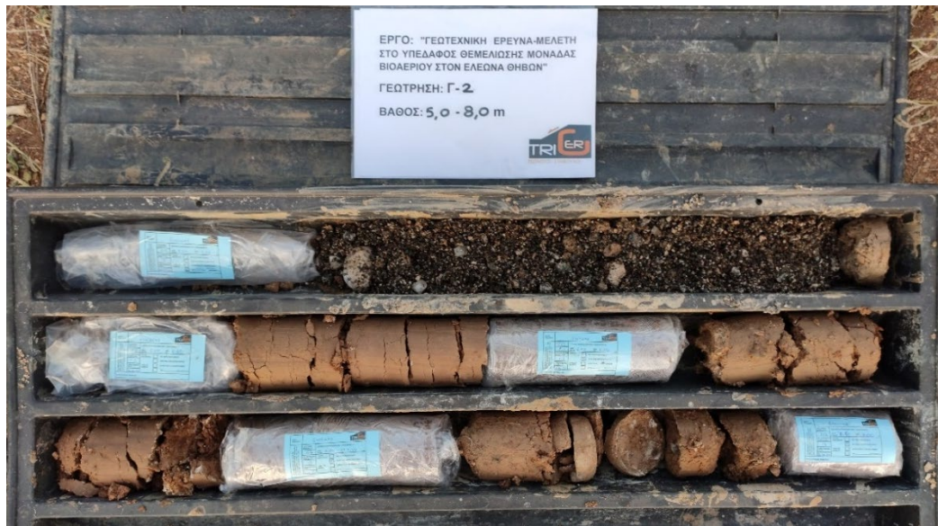
Εικόνα 17: Δειγματοληπτική Γεώτρηση Γ-1 για Βάθος 5,00-8,00m.
