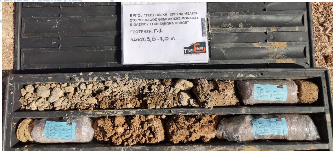
Εικόνα 15: Δειγματοληπτική Γεώτρηση Γ-1 για Βάθος 5,00-7,00m.
