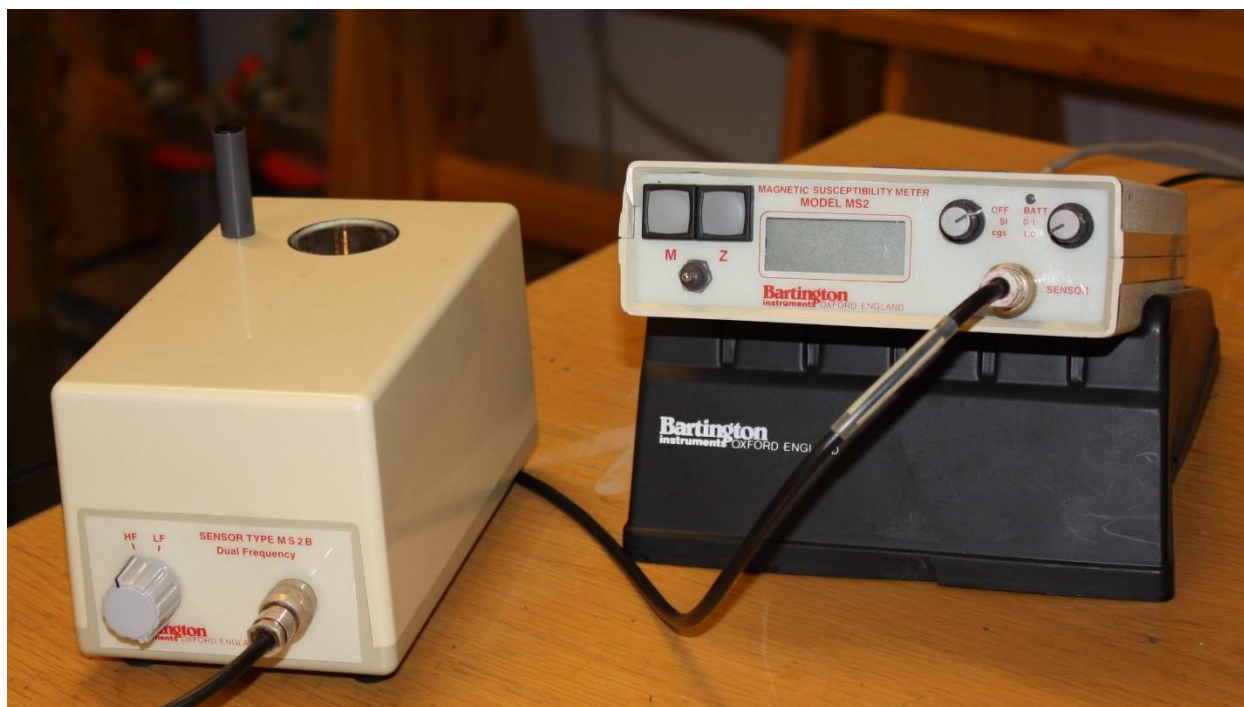
Σχήμα 7. Το μηχάνημα Bartington MS2 laboratory magnetic susceptibility meter (αριστερά) συνδεδεμένο με το MS2B dual frequency sensor (δεξιά) με τα οποία έγιναν οι μετρήσεις της μαγνητικής επιδεκτικότητας.
