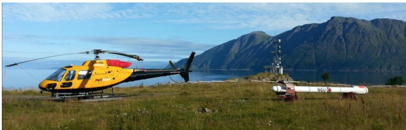
Εικόνα 2: Στη φωτογραφία απεικονίζεται το Eurocopter AS350-B3 της εταιρίας HeliScan AS, κατάλληλα εξοπλισμένο για τις γεωφυσικές από αέρος έρευνες. (NGU, 2014)
