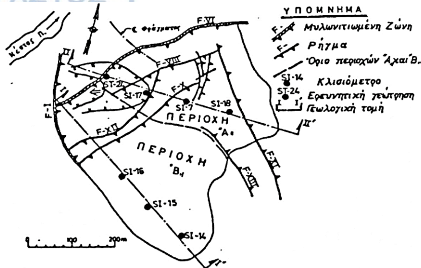
Εικ.33. Κατολίσθηση δεξιού αντερείσματος φράγματος, Δ.Ε. Λιάκουρης (1995).
