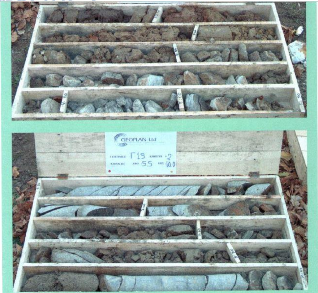
Εικόνα 4.6 Χαρακτηριστικό παράδειγμα βραχομάζας ηφαιστειακών τόφφων σε ζώνη ρήγματος. Παρουσιάζεται πλήρως αποδιοργανωμένη και αποσαθρωμένη με αργιλικό υλικό. Βαθμονόμηση της ταξινόμησης GSI ισούται με 15.
