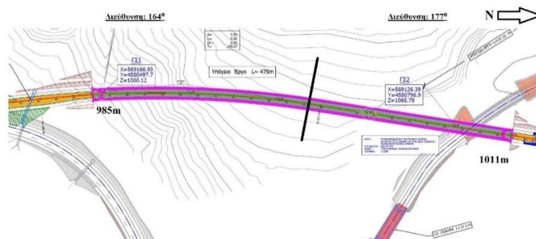
Σχήμα 5.3.1. Τοπογραφική αναπαράσταση της σήραγγας Δημαρίου. Με τη μαύρη συνεχή γραμμή να αποτελεί το όριο των δύο διαφορετικών διευθύνσεων.
