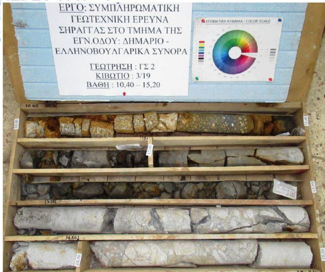
Εικόνα 4.17. Σε βάθος 11.40 έως 13.40m εντοπίζεται η σειρά εναλλαγών ψαμμιτών-ιλυολίθων. Χαρακτηρίζεται από ισχυρό κερματισμό (διατηρείται σε κάποιες περιπτώσεις η δομή) και κυρίως από την έντονη αποσάθρωση της ίδιας πλέον της βραχομάζας λόγω της σχάσης του ιλυολίθου. Βαθμονόμηση GSI ίση με 22.
