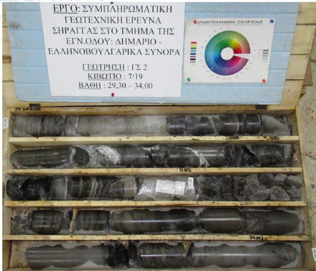
Εικόνα 4.16 Στο βάθος των 31.80m διακρίνεται μια σαφής διαφοροποίηση της σειράς συγκριτικά με τις παραπάνω ενότητες. Η σειρά εμφανίζεται πολύ κερματισμένη έως αποδιοργανωμένη κατά θέσεις. Βαθμονόμηση GSI ίση με 35.
