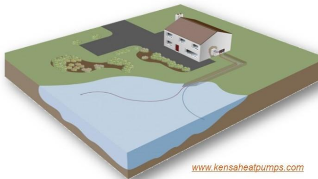
Σχήμα 3: Ανοικτό σύστημα ΓΑΘ συνδεδεμένο με επιφανειακό νερό ( www.kensaheatpumps.com )
