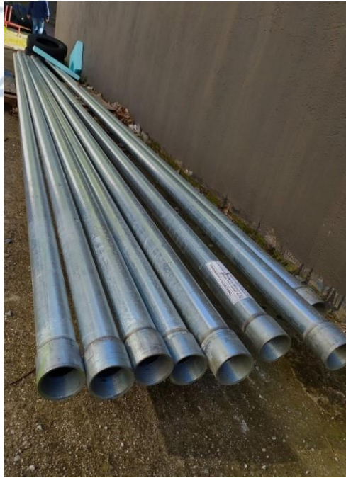
Εικόνα 12: Σωλήνες ομοαξονικού γεωεναλλάκτη
