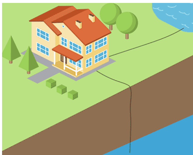
Σχήμα 4: Ανοικτό υβριδικό σύστημα ΓΑΘ ( www.glgeothermal.com )
