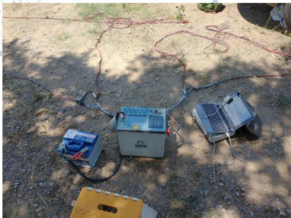
Εικόνα 5.1: Φωτογραφίες από τις μετρήσεις ηλεκτρικής τομογραφίας: το όργανο μέτρησης (αριστερά), συνδεδεμένο ηλεκτρόδιο (κέντρο) και άπλωμα καλωδίου τυλιγμένου σε στροφέιο (δεξιά)
