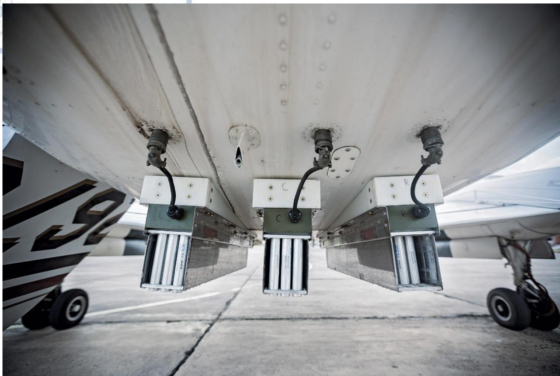
Εικόνα 1.6: Σύστημα εκτόξευσης πυροτεχνικών φυσιγγίων στην άτρακτο του αεροσκάφους (source: Bloomberg.com, photographer: Philippe Calia)
