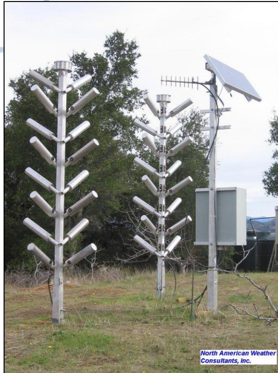
Εικόνα 1.2: Βάση φυσιγγίων ή αλλιώς δέντρο φυσιγγίων (source: North American Weather Consultants, NAWC, Inc)
