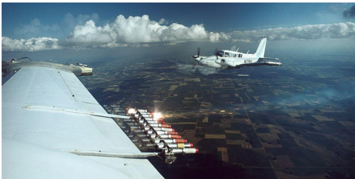
Εικόνα 1.4: Σύστημα αναφλεγόμενων φυσιγγίων στα πτερύγια του αεροσκάφους (source: thenationalnews.com/uae/environment )
