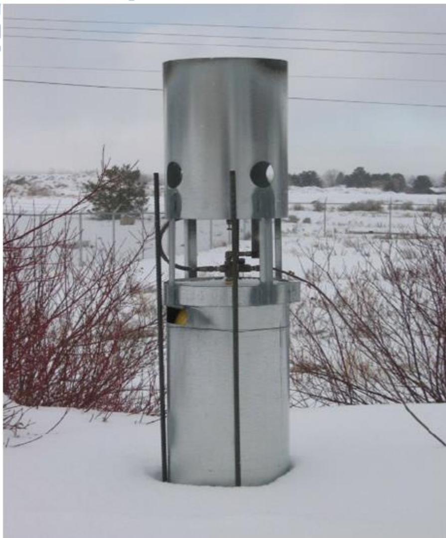
Εικόνα 1.1: Γεννήτρια εδάφους καύσης μίγματος ιωδιούχου άργυρου και ακετόνης (source: North American Weather Consultants, NAWC, Inc)
