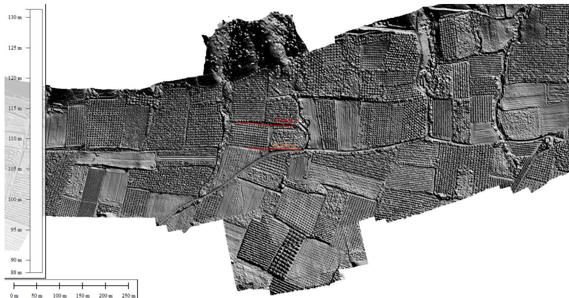
Σχήμα 7-45. Ψηφιακό μοντέλο ΣμηΕΑ με τις επιφάνειες 5 και 6 (Scarp5, Scarp6). . Υπόβαθρο χάρτη νέο ψηφιακό μοντέλο ΣμηΕΑ.
