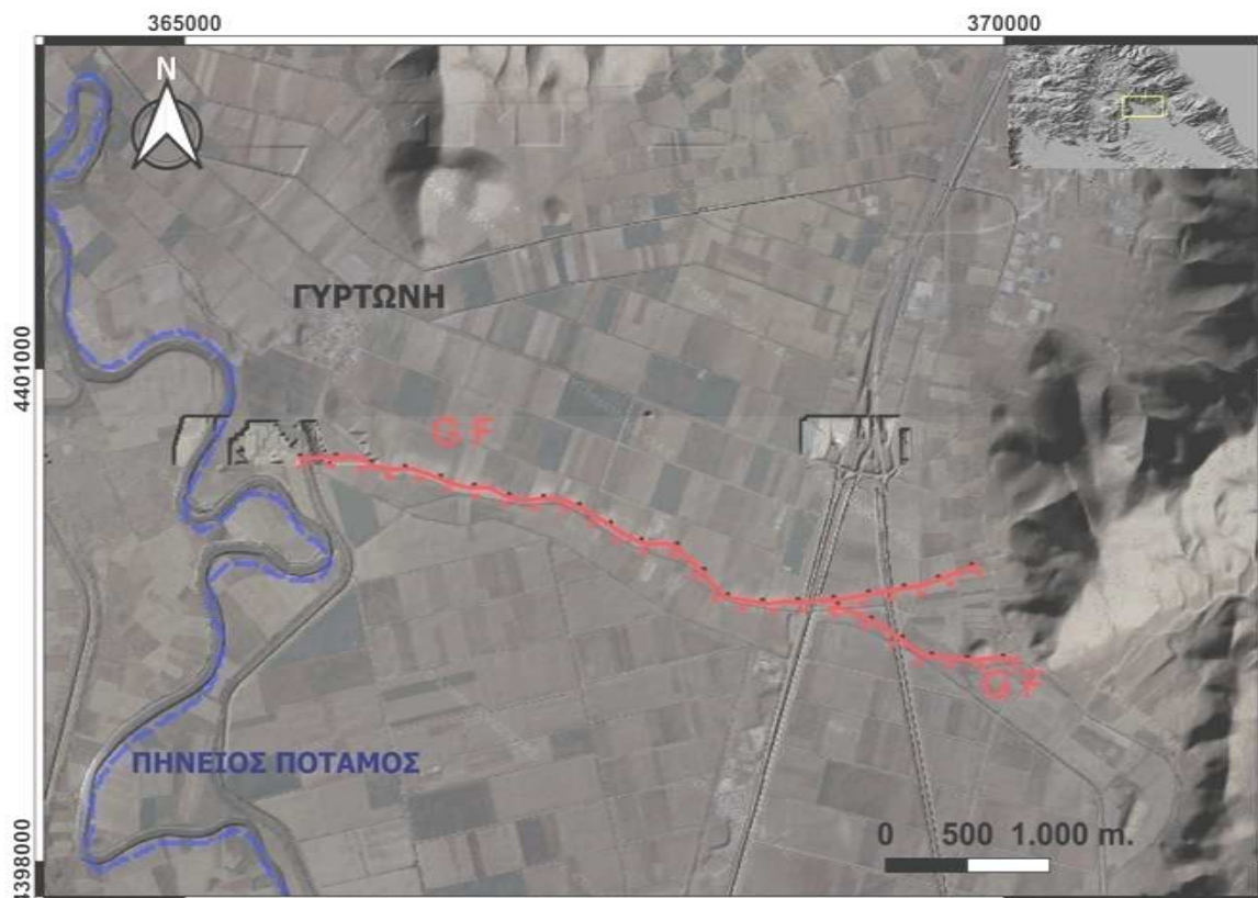
Σχήμα 8-1. Αναλυτικός χάρτης του ρήγματος της Γυρτώνης. Χαρτογράφηση ρήγματος από αναλυτικό ψηφιακό μοντέλο. Εκτιμώμενο επιφανειακό ίχνος 5,64 Km. Υπόβαθρο χάρτη ψηφιακό μοντέλο και ορθοφωτοχάρτης Κτηματολογίου Α.Ε. (2007-2009).
