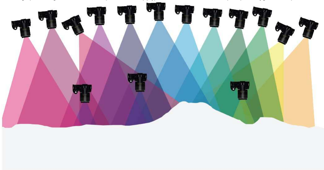
Σχήμα 7-10. Φωτογράφιση με μεγάλη επικάλυψη για την δημιουργία ψηφιακού μοντέλου στο ίδιο ή διαφορετικό υψόμετρο (UNAVCO, Shervais)
