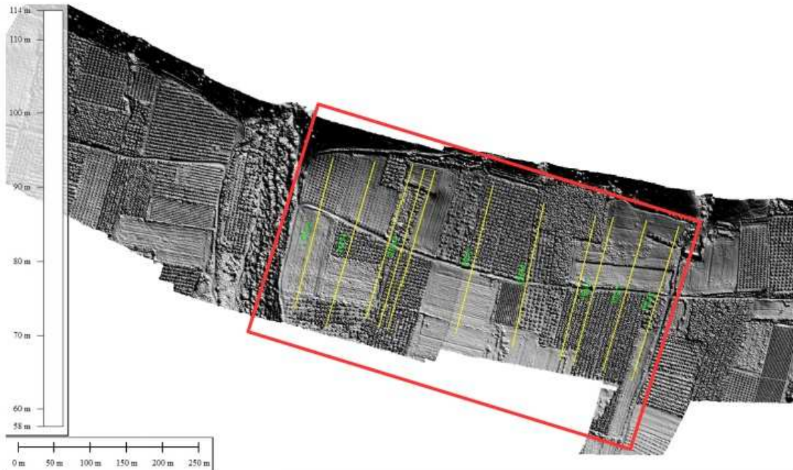
Σχήμα 7-58. Ευρύτερη εικόνα της περιοχής μελέτης (κόκκινο τετράγωνο) με τα εδαφικά προφίλ (κίτρινες γραμμές) που χρησιμοποιήθηκαν για την ανάλυση. Υπόβαθρο χάρτη νέο ψηφιακό μοντέλο ΣμηΕΑ.
