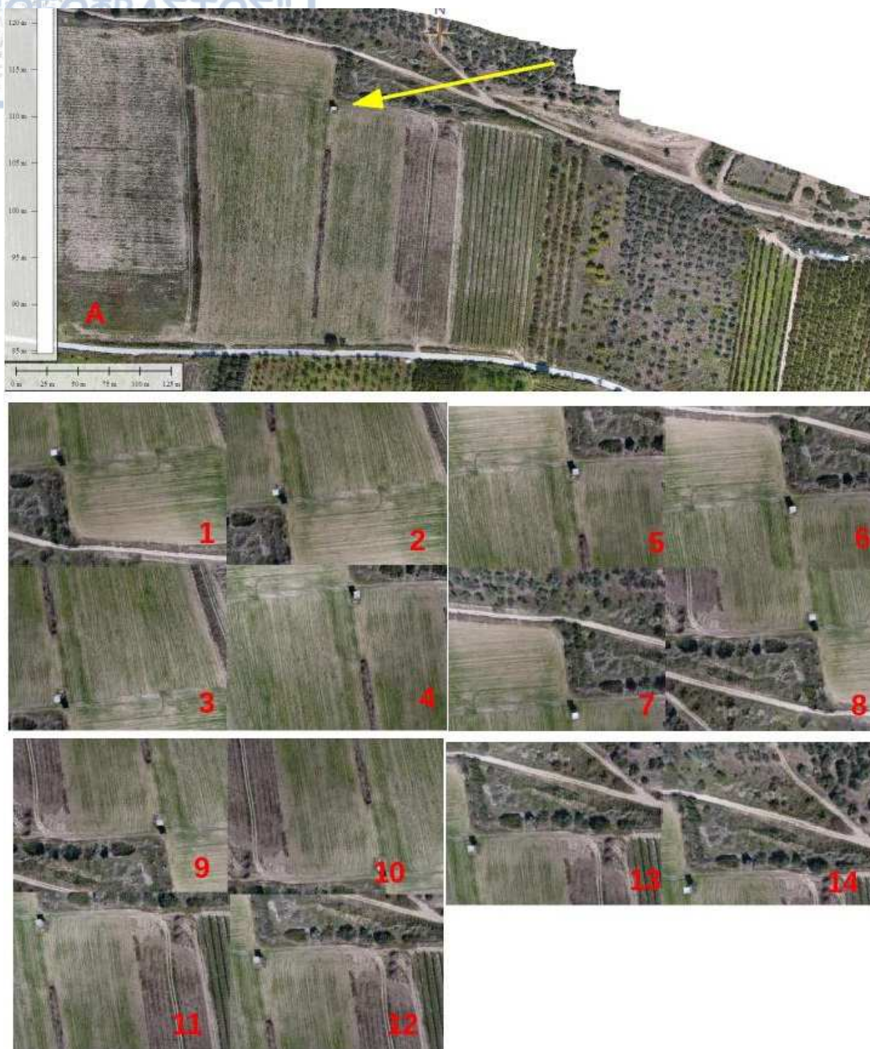
Σχήμα 7-12. Παράδειγμα αεροφωτογράφισης για την δημιουργία ψηφιακού μοντέλου. Για την χαρτογράφηση της περιοχής της εικόνας (A, οίκημα, κίτρινο βέλος), συνολικά σύμφωνα με την τεχνική SfM απαιτήθηκαν δεκατέσσερις (14) αεροφωτογραφίες της περιοχής για την δημιουργία του ψηφιακού μοντέλου. Εικόνες από την εναέρια φωτογράφιση στην περιοχή της Ροδιάς.
