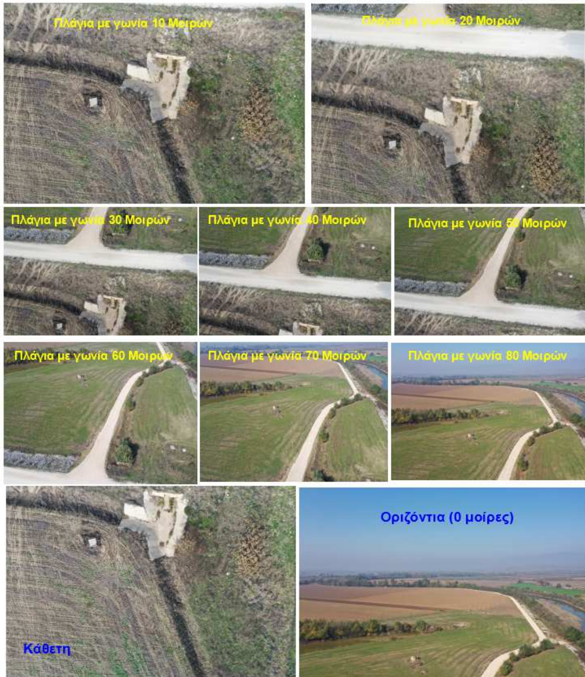
Σχήμα 7-106. Μέθοδοι αεροφωτογράφισης σε σχέση με την γωνία λήψεως της φωτογραφικής κάμερας, σε περιοχή με ομαλή κλίση και ήπιο ανάγλυφο στην περιοχή στην Γυρτώνης.
