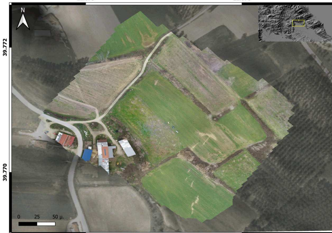
Σχήμα 5-11. Χαρτογράφηση περιοχών ρευστοποιήσεων με την χρήση ΣμηΕΑ και παραγωγή ορθοφωτοχάρτων και αναλυτικών ψηφιακών μοντέλων, υπόβαθρο χάρτη ψηφιακό μοντέλο και ορθοφωτοχάρτης (2007-2009) Κτηματολογίου.
