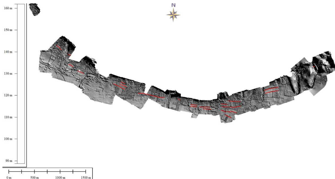
Σχήμα 7-85. Ανατολική περιοχή της Ροδιάς, μετά τον οικισμό του Αργυροπουλίου, εικόνα ψηφιακού μοντέλου ΣμηΕΑ, με τις ρηξιγενείς επιφάνειες (κόκκινες γραμμές).
