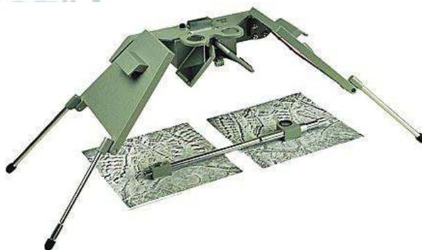
Σχήμα 7-2. Όργανο παραδοσιακής στέρεο – φωτογραμμετρίας (Edwin 2014)
