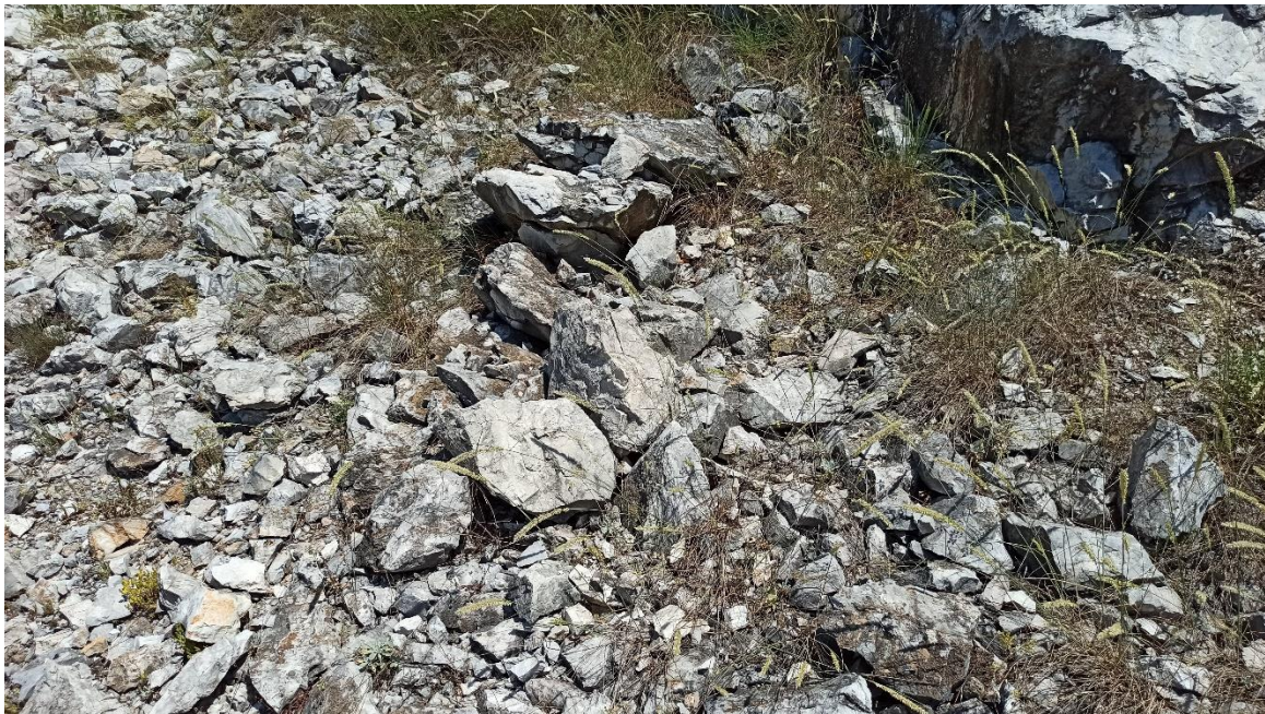
Εικόνα 3.39 Τεχνικογεωλογική ενότητα 3: Τα τεμάχια που βρέθηκαν στο πόδα του πρανούς.
