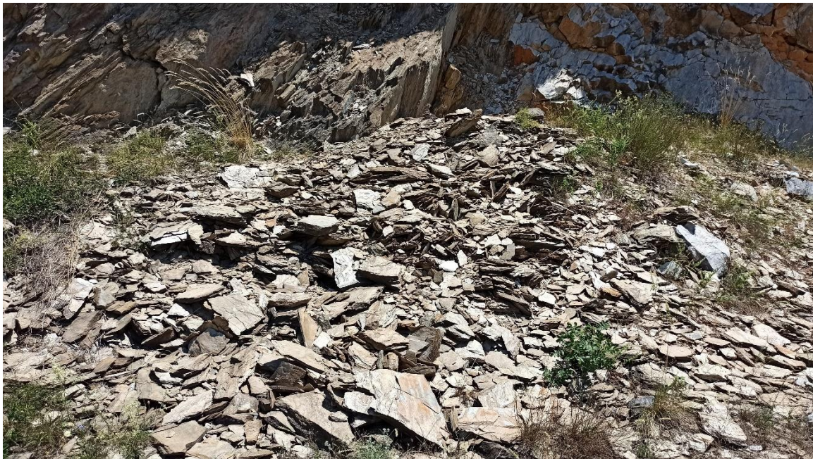
Εικόνα 3.29 Τεχνικογεωλογική ενότητα 1: Τα τεμάχια που βρέθηκαν στον πόδα του πρανούς.
