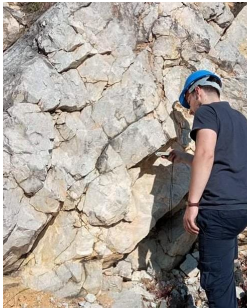
Εικόνα 3.21 Καταγραφή τεκτονικών στοιχείων με γεωλογική πυξίδα (τεχνικογεωλογική ενότητα 2).
