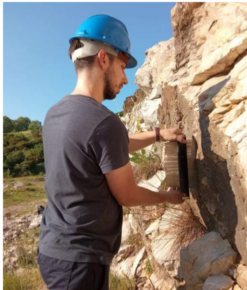
Εικόνα 3.24 Τοποθέτηση προφιλόμετρου παράλληλα με την επιφάνεια της ασυνέχειας. (τεχνικογεωλογική ενότητα 3)
