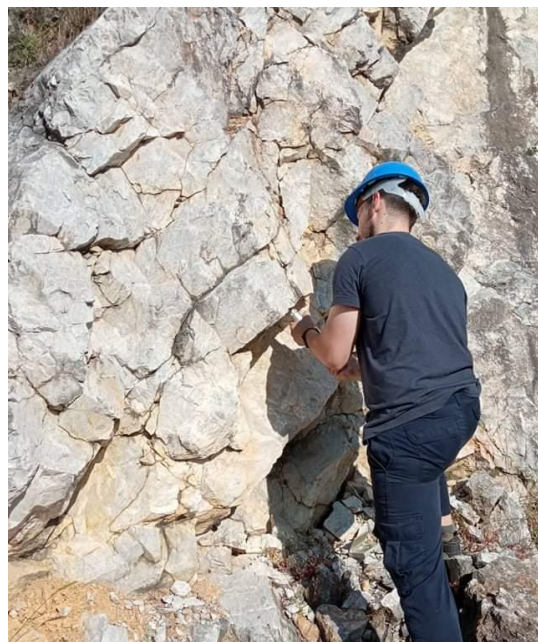
Εικόνα 3.23 Κρουσιμέτρηση με σφύρα Schmidt (τεχνικογεωλογική ενότητα 2).
