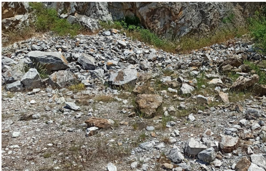
Εικόνα 3.34 Τεχνικογεωλογική ενότητα 2: Τα τεμάχια που βρέθηκαν στο πόδα του πρανούς.
