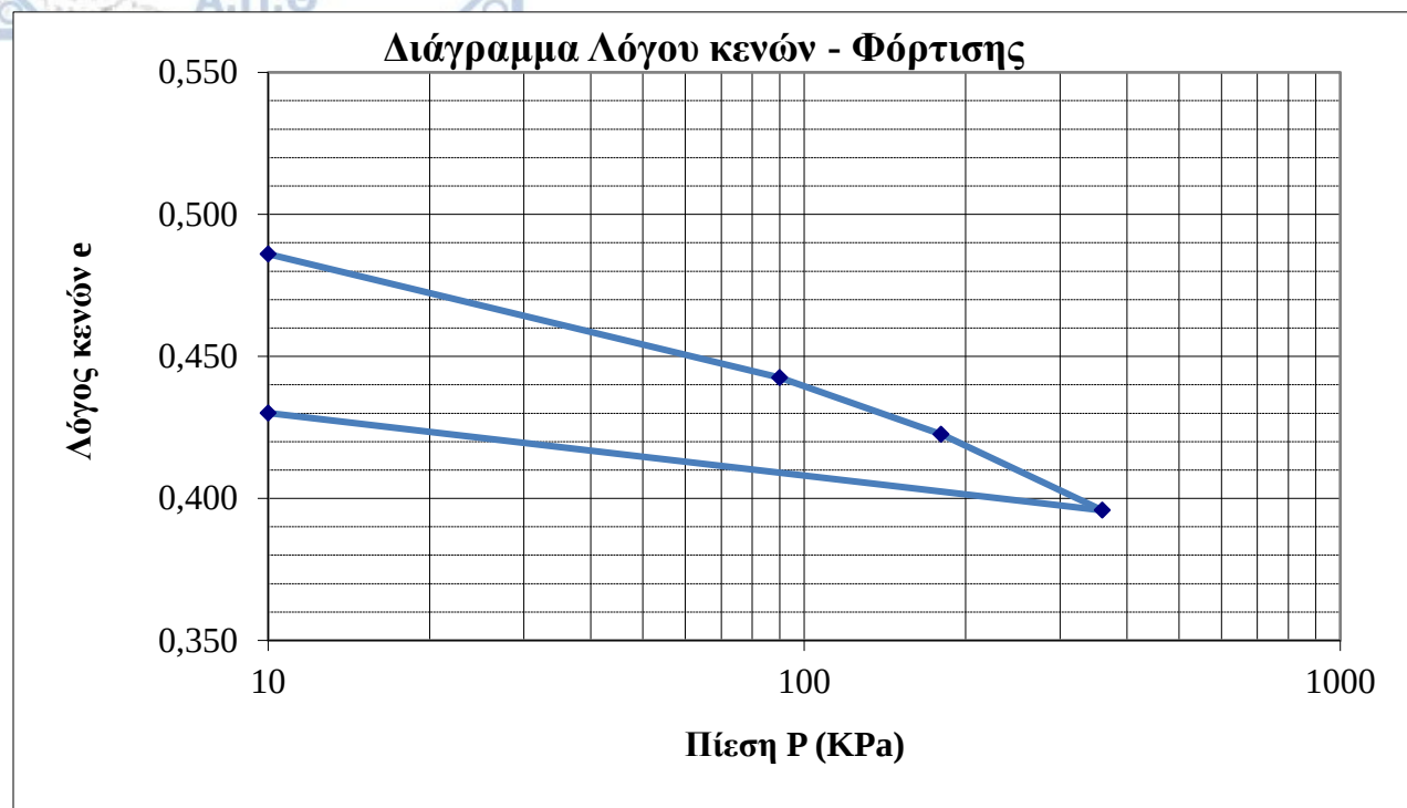
Εικόνα 46: Διάγραμμα Λόγου κενών – φόρτισης σε μονοδιάστατη στερεοποίηση ( \Gamma I = 4,65 - 5,00 m).
