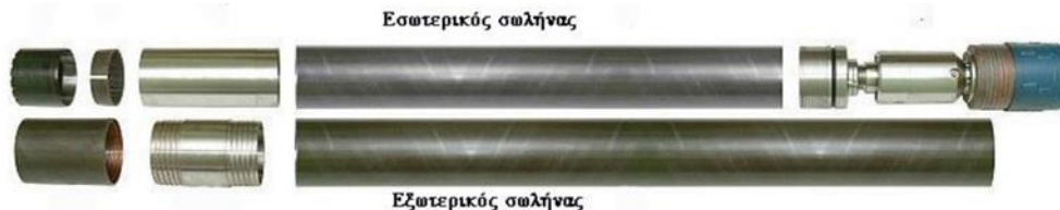
Εικόνα 22: Δειγματολήπτης διπλού σωλήνα (πηγή: http://www.geo.auth.gr/courses/ggg/ggg875e/assets/texnikh-gewtrhsewn-shmeiwseis-mathhmatos.pdf )
