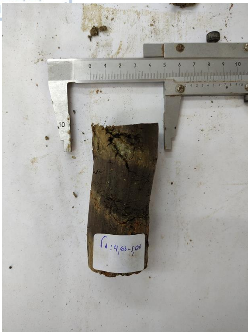
Εικόνα 48: Το εδαφικό δείγμα της Γ1: 4,65 – 5,00 ύστερα από την δοκιμή ανεμπόδιστης θλίψης. Στην εικόνα φαίνεται και επιφάνεια αστοχίας του υλικού.
