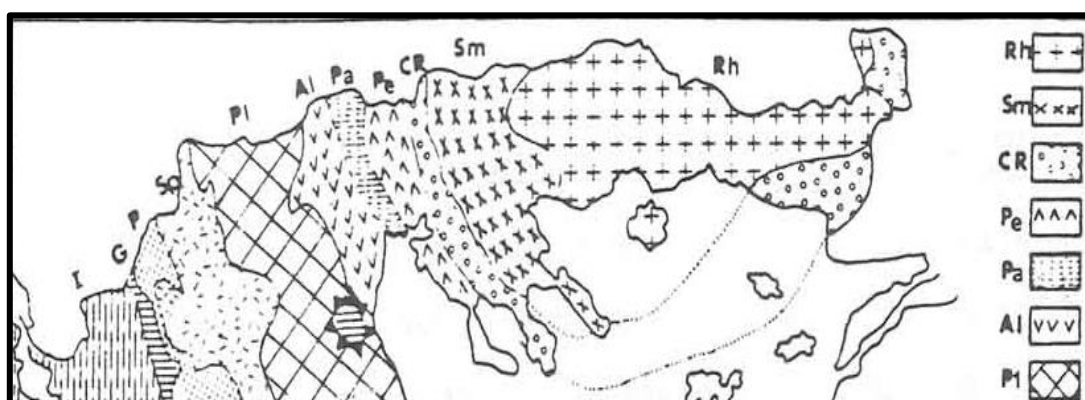
Σχήμα 5. Γεωτεκτονικό σχήμα των Ελληνίδων ζωνών. Rh: Μάζα της Ροδόπης, Sm: Σερβομακεδονική μάζα, CR: Περιοδοπική ζώνη, (Pe: Ζώνη Παιονίας, Pa: Ζώνη Πάικου, Al: Ζώνη Αλμωπίας) = Ζώνη Αξιού, (Κατά Mountrakis et al.) 1983
