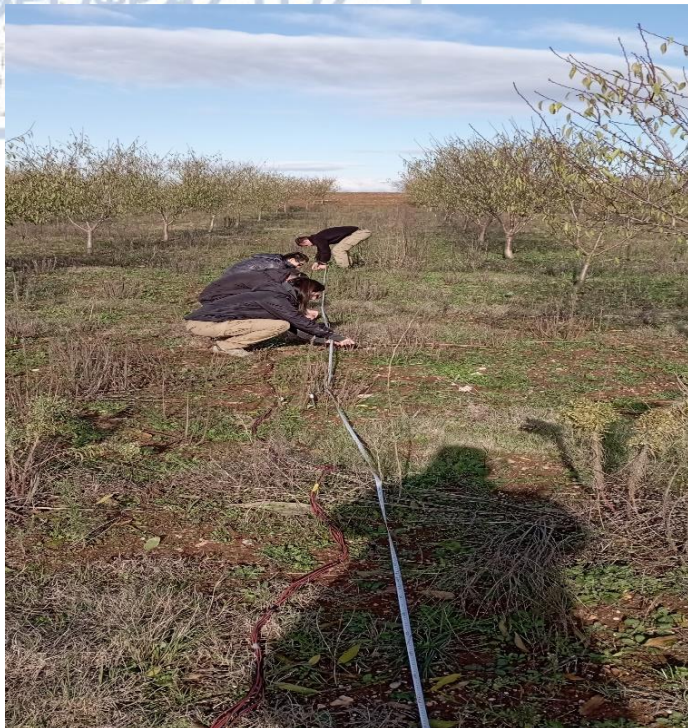
Εικόνα 3.2.3 Τοποθέτηση ηλεκτροδίων και πολυκάναλων καλωδίων
