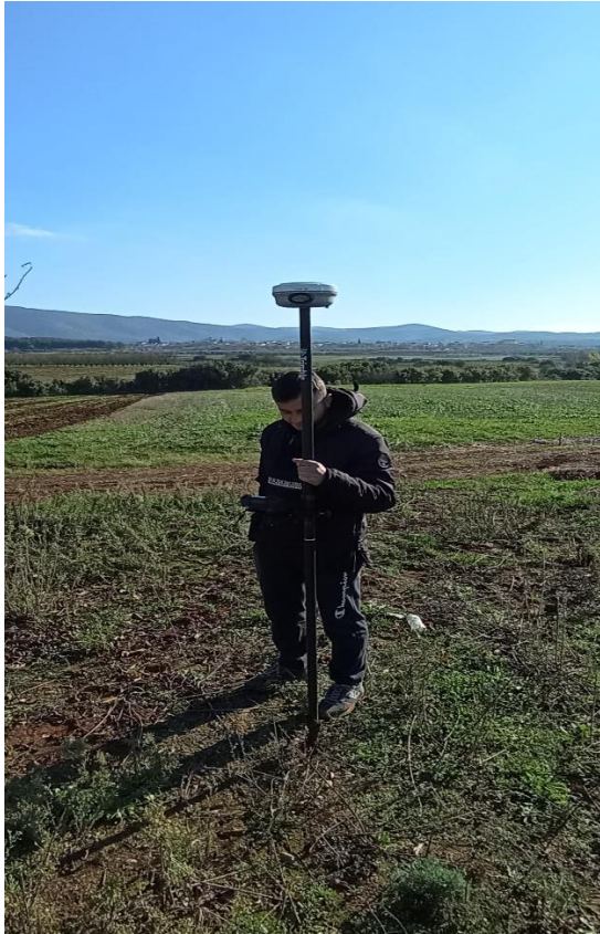
Εικόνα 3.2.4 Τοπογραφική αποτύπωση κάθε γραμμής μελέτης
