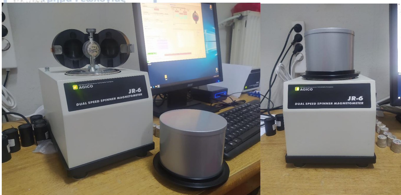
Σχήμα 8: Το περιστροφικό μαγνητόμετρο που χρησιμοποιήθηκε για τις μετρήσεις NRM, ARM και IRM.
