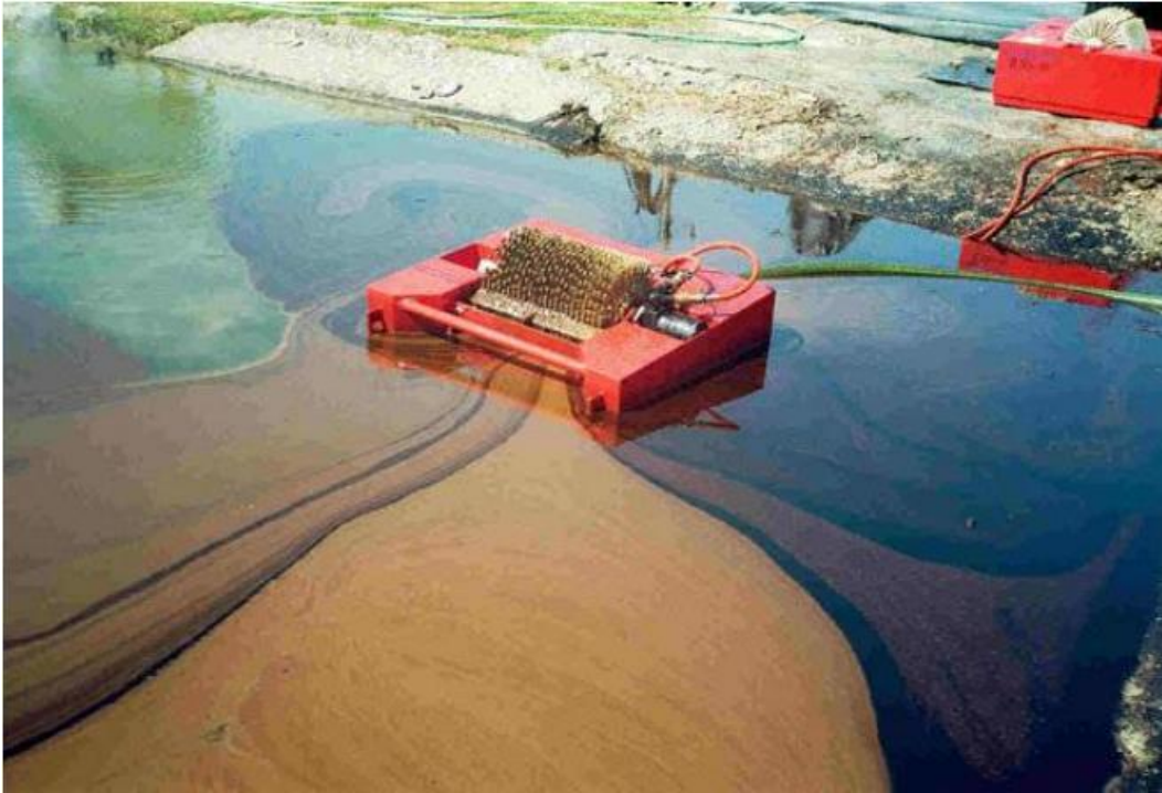
Εικόνα 18: Χρήση skimmer για ανάκτηση πετρελαίου (Πηγή: https://aquaguard.com/products/skimmers/rbs-triton-35-skimmer )
