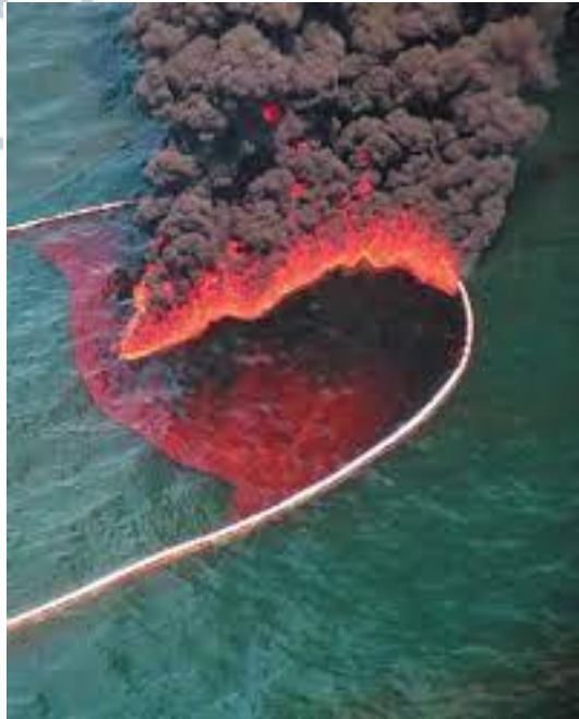
Εικόνα 20: Ελεγχόμενη επιτόπια καύση με τη χρήση Booms (Πηγή: https://www.giwacaf.net/en/publications/in-situ-burning-ipieca-gpg )
