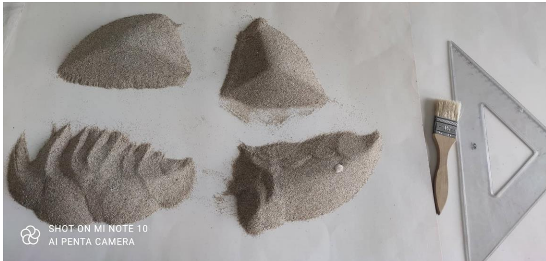
Εικόνα 55 : Διχοτόμηση δείγματος με την μέθοδο του σταυρού.
