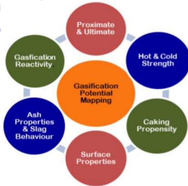
Εικόνα 7: Παράμετροι αεριοποίησης ανθράκων με υψηλά ποσοστά τέφρας. (ICG – 100MT)
