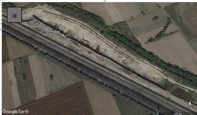
Εικόνα 4.4 α) Δορυφορικές φωτογραφίες του προσωρινού χώρου απόθεσης τέφρας A9 ΒΔ του Α.Η.Σ Αγίου Δημητρίου και β) του προσωρινού χώρου μεταφόρτωσης τέφρας περιορισμένης έκτασης και σε μεγαλύτερη απόσταση από τον Α.Η.Σ.
