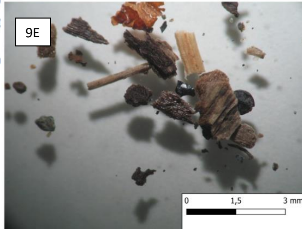
Εικόνα Α.9Ε Μικροφωτογραφία από τη στερεοσκοπική παρατήρηση του δείγματος 9Ε στην οποία αποτυπώνονται μη μαγνητικοί κόκκοι λευκοκρατικών ορυκτών καθώς και ένας κόκκος πιθανόν ιλμενίτη στο κάτω μέρος της χρώματος καφέ (ΠΑΡΑΡΤΗΜΑ II : ΜΙΚΡΟΦΩΤΟΓΡΑΦΙΕΣ ΣΤΕΡΕΟΣΚΟΠΙΟΥ).
