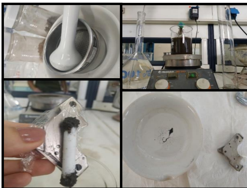
Εικόνα 3.2 Διαδικασία εξαγωγής του μαγνητικού κλάσματος όπως αυτή πραγματοποιήθηκε στο Χημείο του Τομέα Ορυκτολογίας-Πετρολογίας-Κοιτασματολογίας, του Τμήματος Γεωλογίας, του Α.Π.Θ.
