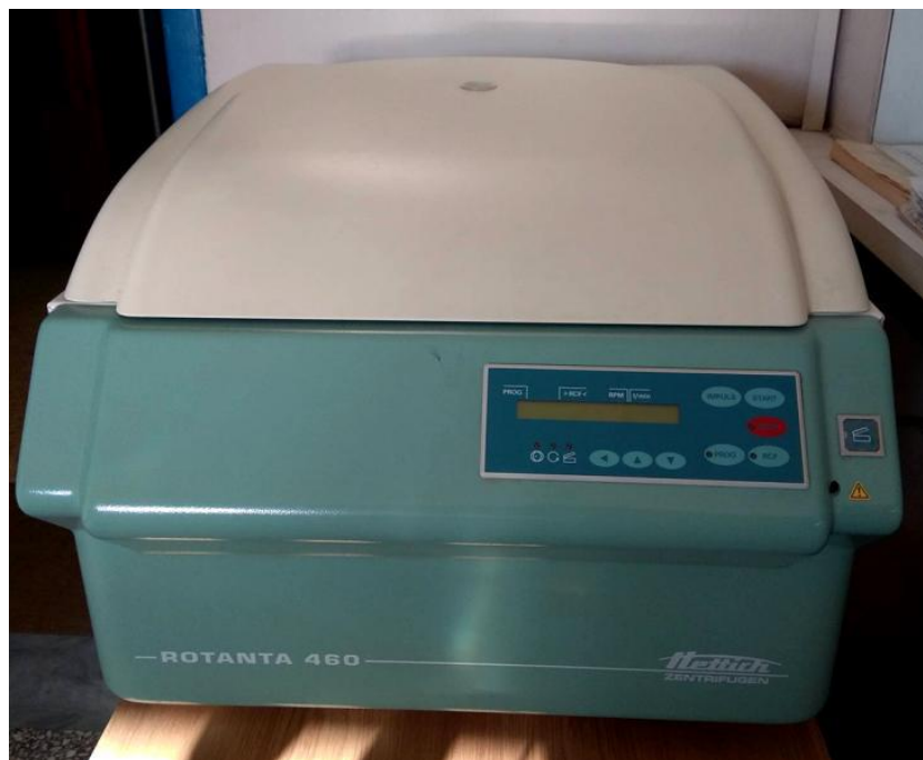
Εικόνα 3.3. Φυγόκεντρος τύπου Rotanda 460 του τομέα Ορυκτολογίας-Πετρολογίας-Κοιτασματολογίας του τμήματος Γεωλογίας Α.Π.Θ (Βούτα, 2018).
