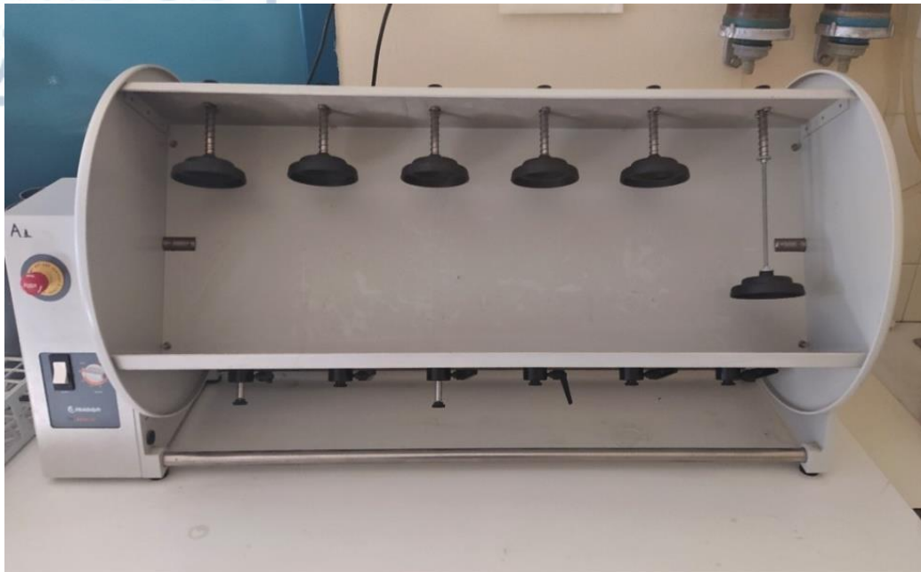
Εικόνα 3.2. Συσκευή ανάδευσης Heidolph® τύπου Reax 20/12 του τομέα Ορυκτολογίας-Πετρολογίας-Κοιτασματολογίας του τμήματος Γεωλογίας Α.Π.Θ.
