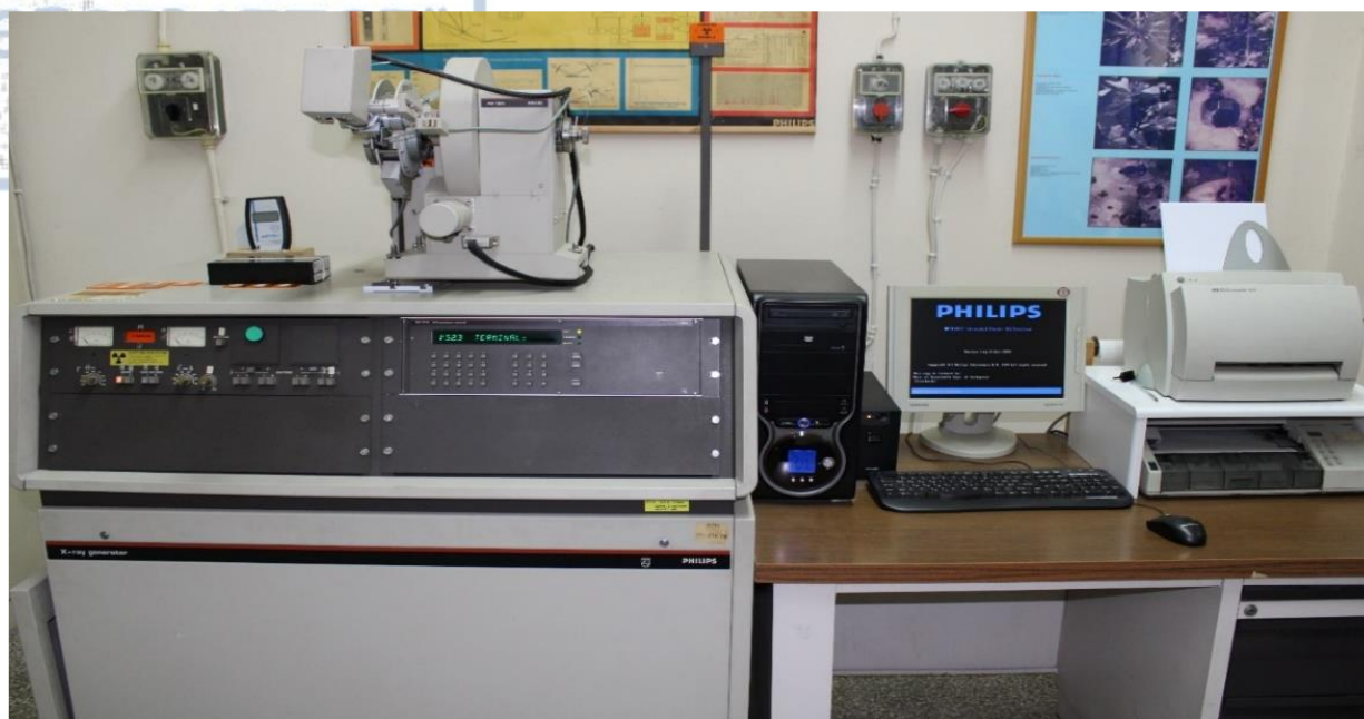
Εικόνα 3.1. Περιθλασιόμετρο ακτίνων X τύπου Philips PW1820/00 του Τομέα Ορυκτολογίας-Πετρολογίας-Κοιτασματολογίας Α.Π.Θ.
