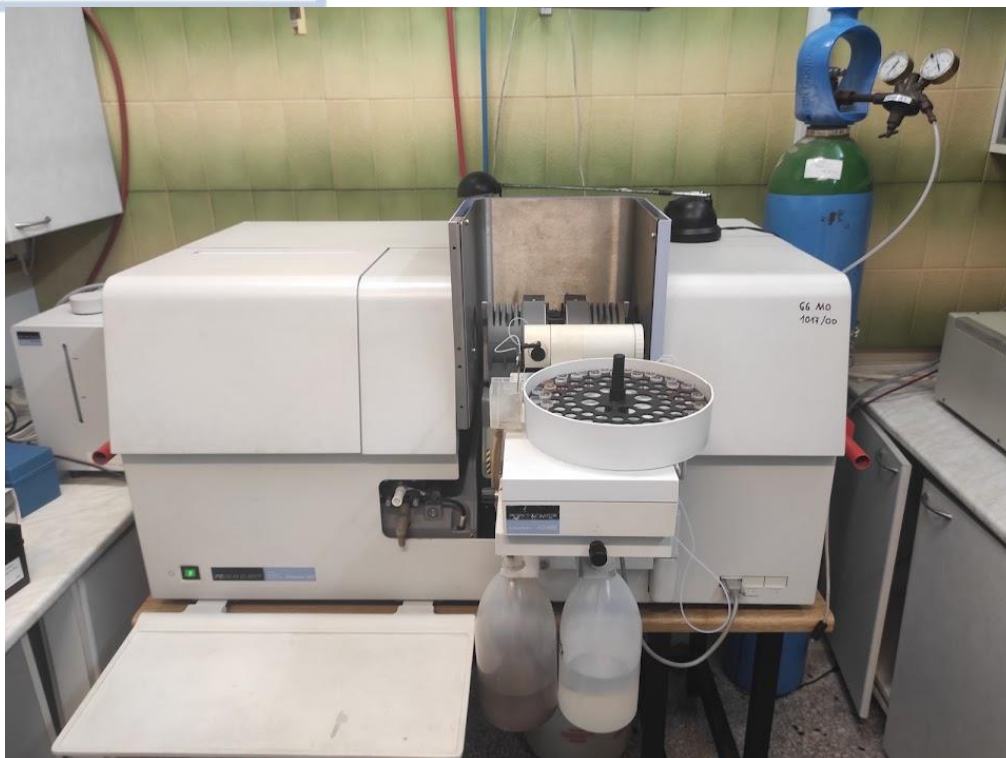
Εικόνα 3.4. Φασματόμετρο Perkin Elmer AAnalyst 800 εξοπλισμένο με φούρνο γραφίτη του εργαστηρίου Αναλυτικής Χημείας του Τμήματος Χημικών Μηχανικών Α.Π.Θ.
