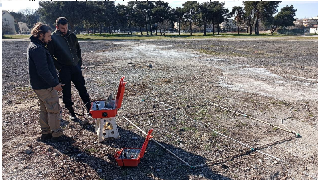
Εικόνα 4.2.4 Μετρήσεις παροδικών πεδίων με το Wtem-2 και ο βρόγχος που χρησιμοποιήθηκε.
