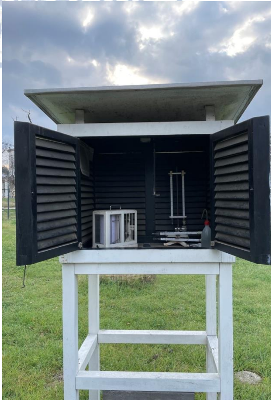
Σχήμα 2.1: Μετεωρολογικός κλωθός εντός του σταθμού του Μετεωροσκοπίου, μέσα στο κλωθό διακρίνονται ο θερμοϋγρογράφος και τα Ακροβάθμια θερμόμετρα.
