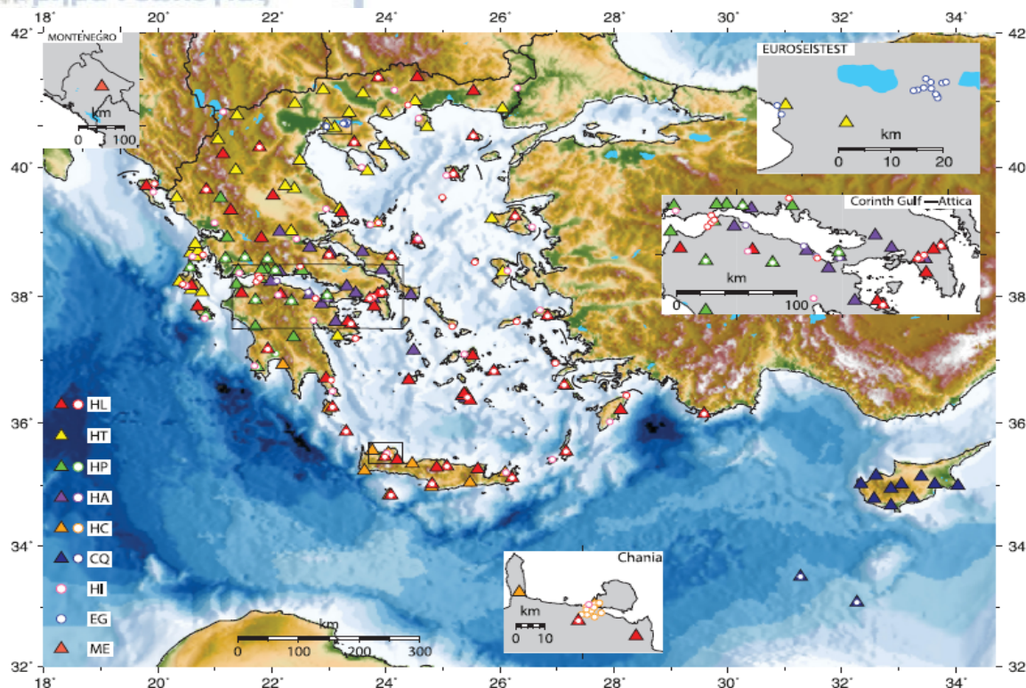
Σχήμα 2.5: Οι σεισμολογικοί σταθμοί που λειτουργούν στην Ελλάδα και τις γειτονικές χώρες. Με τρίγωνα συμβολίζονται οι σταθμοί με σεισμόμετρα ευρέος φάσματος (BB), ενώ με κύκλους συμβολίζονται οι επιταχυνσιογράφοι (SM). Οι σταθμοί έχουν χρωματική κωδικοποίηση ανάλογα στο δίκτυο το οποίο ανήκουν. Στους ένθετους χάρτες εμφανίζονται τα τοπικά δίκτυα.
