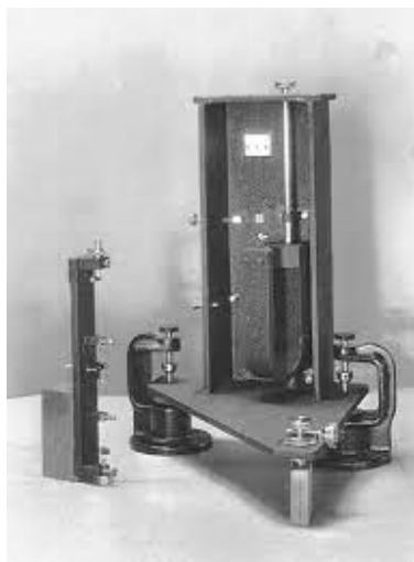
Σχήμα 2.3: Οριζόντιος σεισμογράφος Wood_Anderson (W-A) ( https://www.gein.noa.gr/HTML/WEB-EDU/instruments.html )
