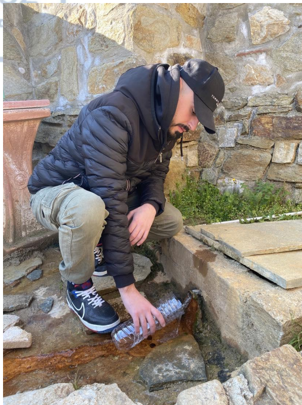
Σχήμα 2.2 Μέτρηση παροχής νερού στην πηγή Αγίασμα.
