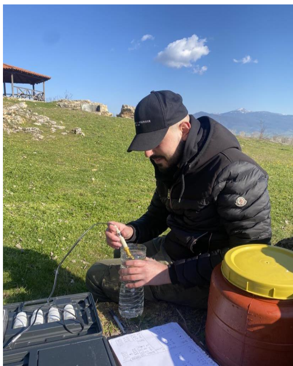
Σχήμα 2.3 Μέτρηση Φυσικοχημικών παραμέτρων στην πηγή Βοσκίνα.
