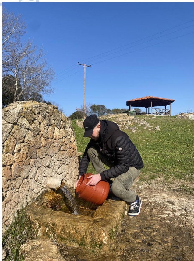
Σχήμα 2.4 Μέτρηση παροχής νερού στην πηγή Βοσκίνα.
