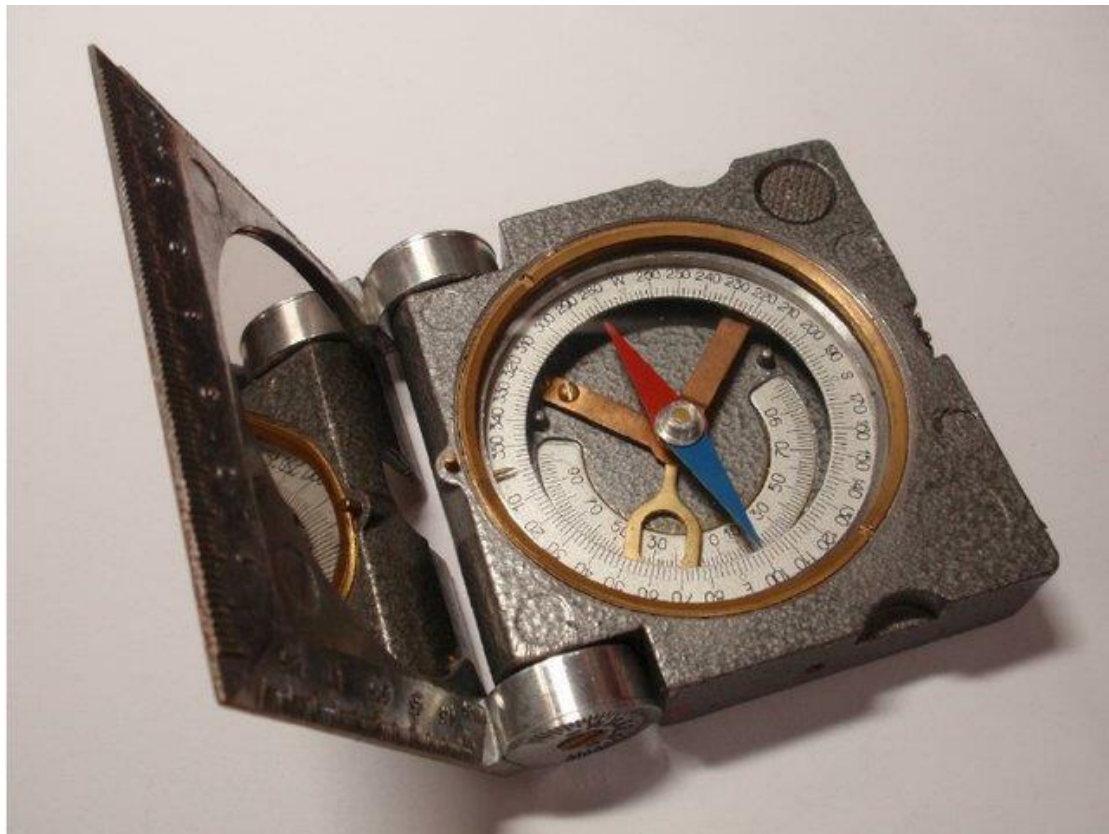
Εικόνα 9: Κατοπτρική Γεωλογική πυξίδα κατά CLAR (Kalantari B. & Jamali H., 2015)
