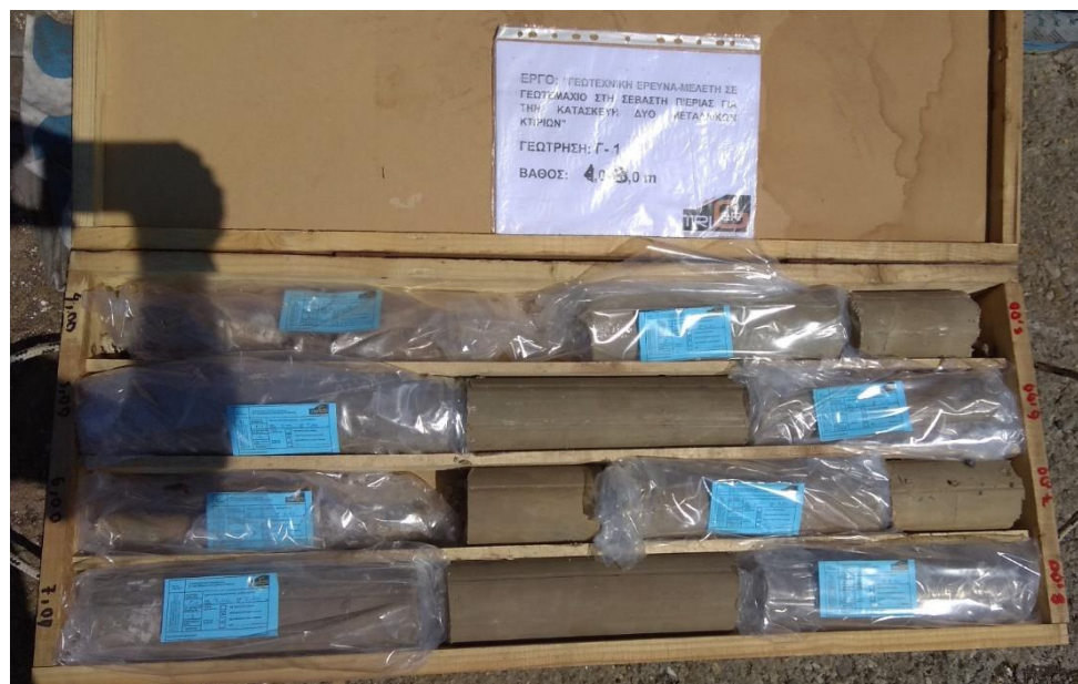
Εικόνα 58: Δειγματοληπτική Γεώτρηση Γ1, Βάθος 9,00-12,00m
