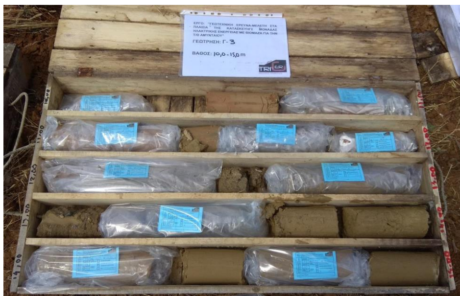
Εικόνα 54: Δειγματοληπτική Γεώτρηση Γ3, Βάθος 10,00-15,00m
