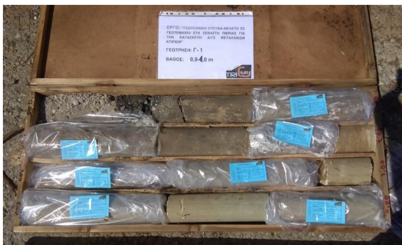
Εικόνα 20: Δειγματοληπτική Γεώτρηση Γ1, Βάθος 0,00-4,00m
