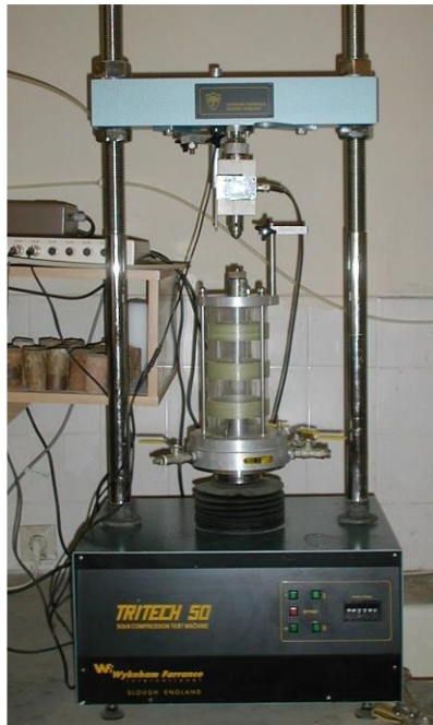
Εικόνα 38: Τριαξονική συσκευή GDS του Εργαστηρίου Τεχνικής Γεωλογίας και Υδρογεωλογίας, Τμήμα Γεωλογίας ΑΠΘ
