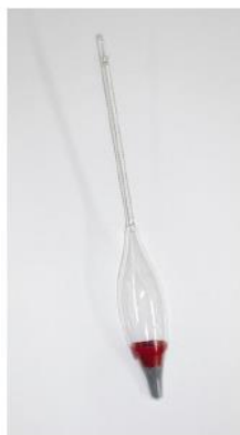
Αραιόμετρο (ή υδρόμετρο 152) μέτρησης των εν αιωρήσει κόκκων
