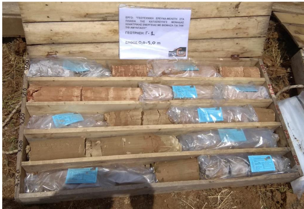
Εικόνα 18: Δειγματοληπτική Γεώτρηση Γ1, Βάθος 0,00-5,00m (ενδεικτικό παράδειγμα, το σύνολο των εικόνων από τις γεωτρήσεις παρατίθεται στο ΠΑΡΑΡΤΗΜΑ )
