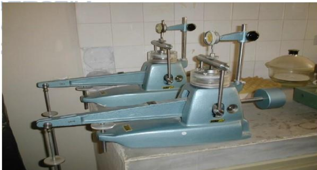
Εικόνα 37: Οιδήμετρα στο Εργαστήριο Τεχνικής Γεωλογίας και Υδρογεωλογίας του Τμήματος Γεωλογίας
