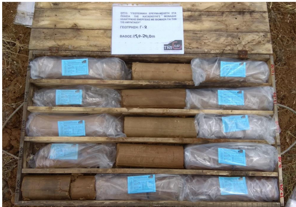
Εικόνα 51: Δειγματοληπτική Γεώτρηση Γ2, Βάθος 15,00-20,00m
