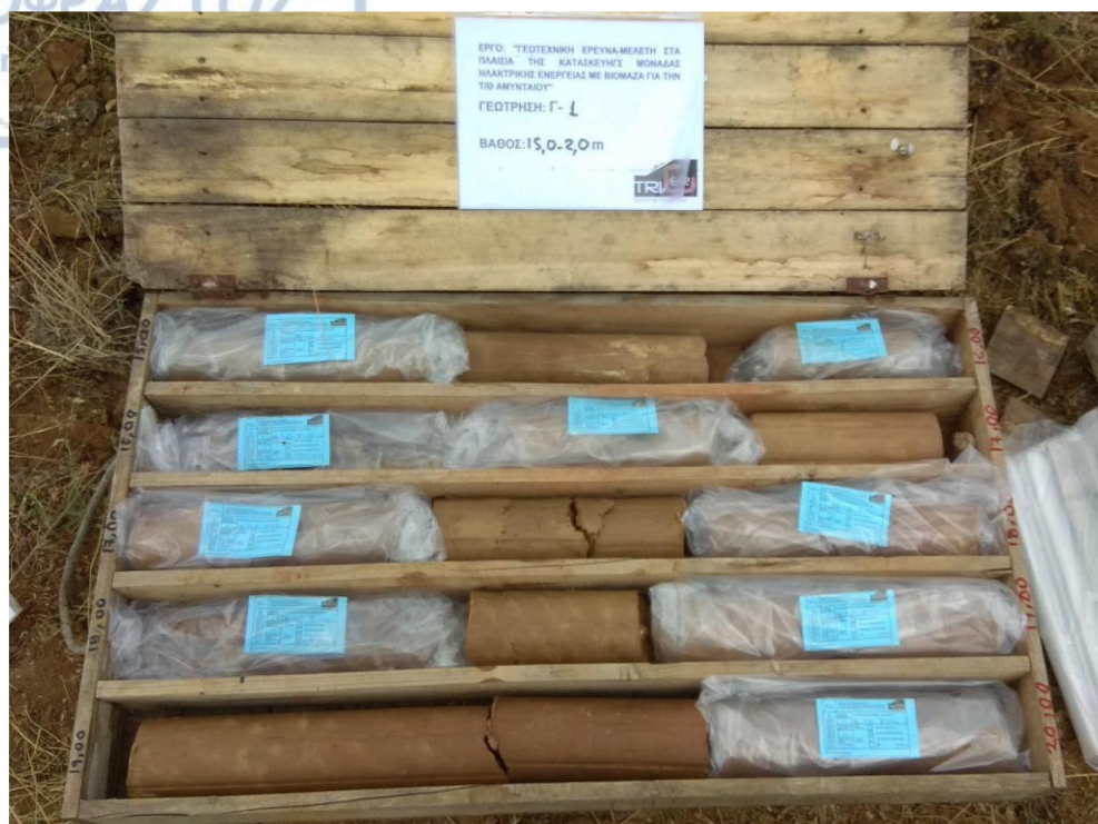
Εικόνα 47: Δειγματοληπτική Γεώτρηση Γ1, Βάθος 15,00-20,00m
