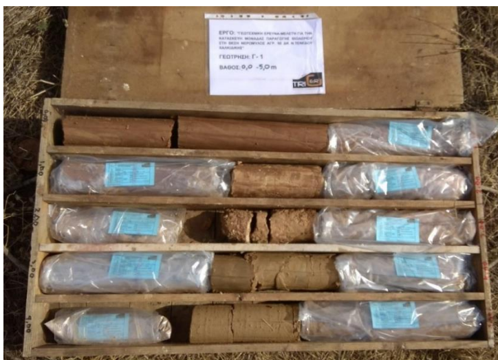
Εικόνα 19: Δειγματοληπτική Γεώτρηση Γ1, Βάθος 0,00-5,00m
