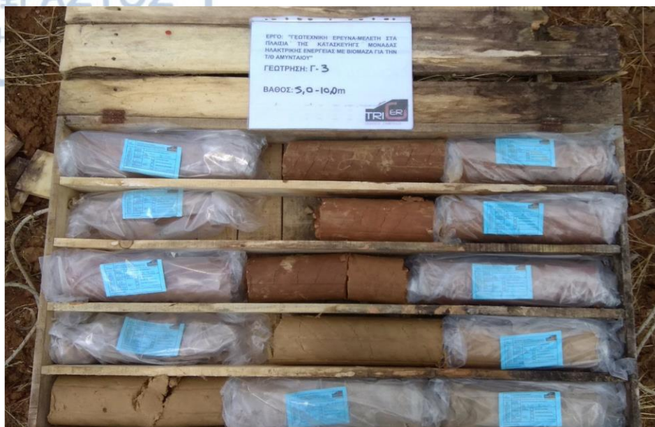
Εικόνα 53: Δειγματοληπτική Γεώτρηση Γ3, Βάθος 5,00-10,00m
