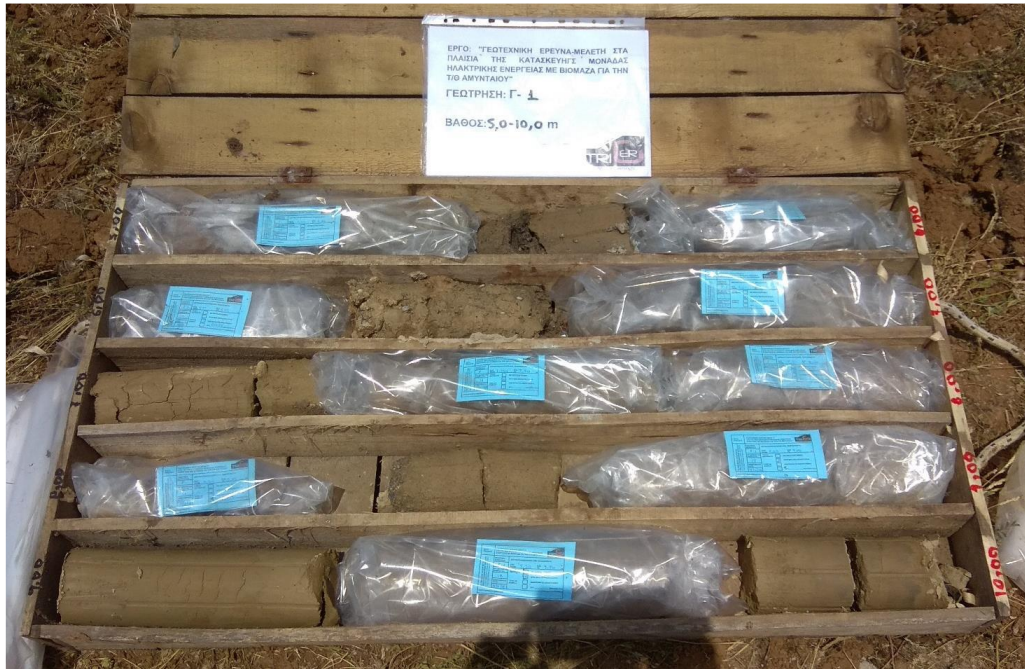
Εικόνα 45: Δειγματοληπτική Γεώτρηση Γ1, Βάθος 5,00-10,00m
