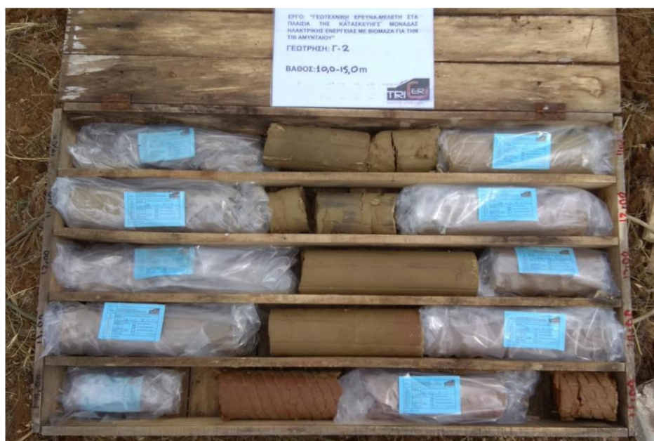
Εικόνα 50: Δειγματοληπτική Γεώτρηση Γ2, Βάθος 10,00-15,00m
