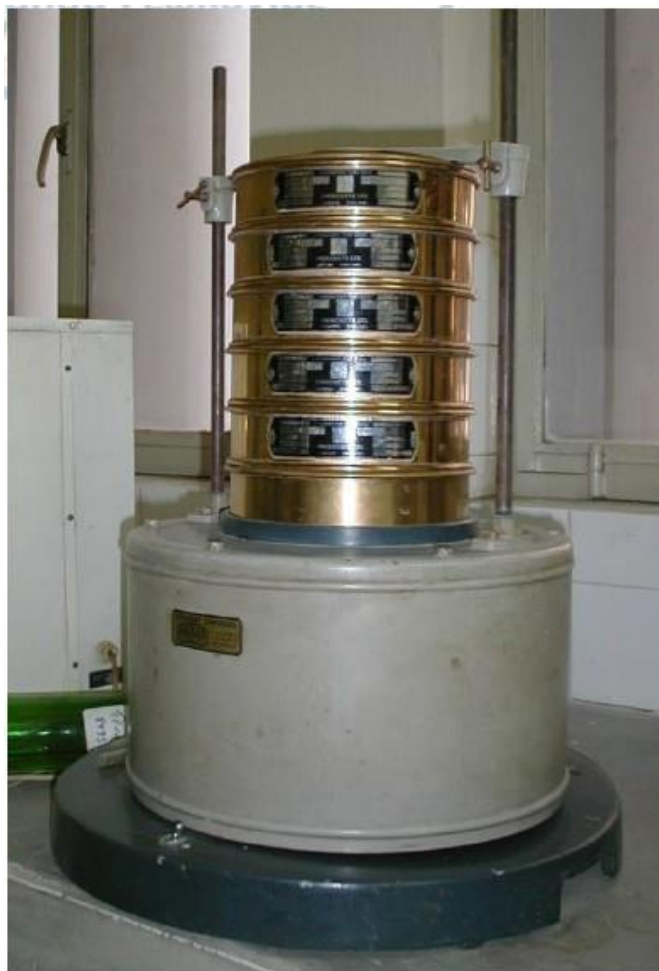
Εικόνα 35: Κόσκινα τοποθετημένα στη συσκευή κοσκινίσματος στο Εργαστήριο Τεχνικής Γεωλογίας και Υδρογεωλογίας του Τμήματος Γεωλογίας Α.Π.Θ
