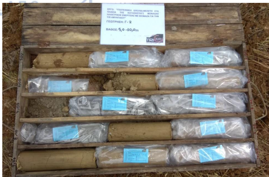
Εικόνα 49: Δειγματοληπτική Γεώτρηση Γ2, Βάθος 5,00-10,00m
