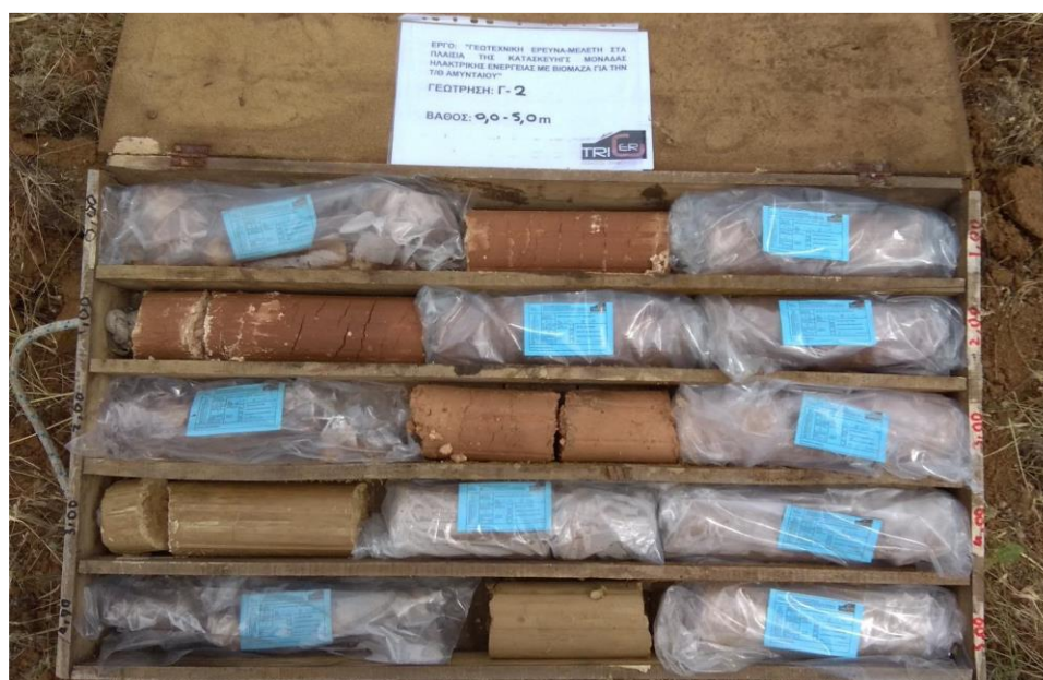
Εικόνα 48: Δειγματοληπτική Γεώτρηση Γ2, Βάθος 0,00-5,00m
