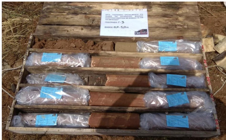
Εικόνα 52: Δειγματοληπτική Γεώτρηση Γ3, Βάθος 0,00-5,00m
