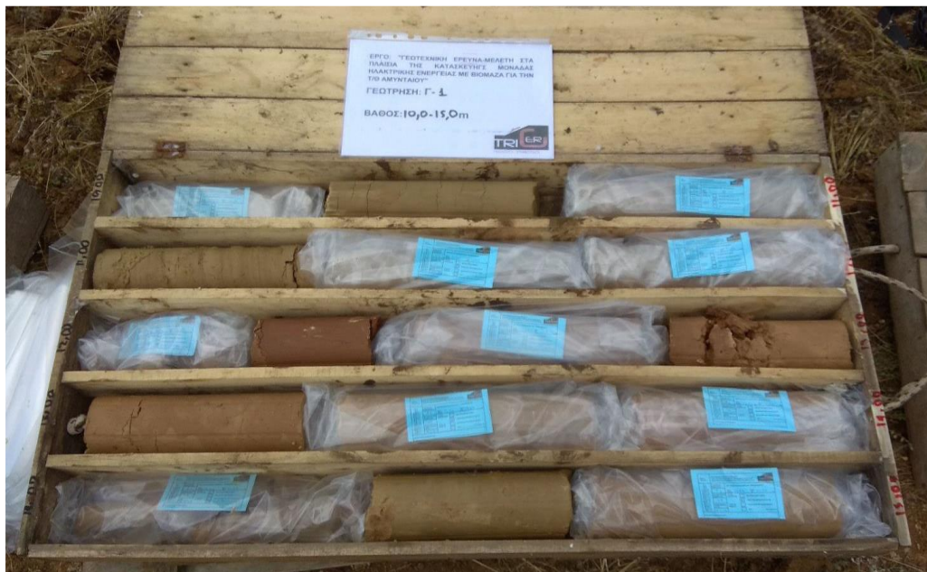
Εικόνα 46: Δειγματοληπτική Γεώτρηση Γ1, Βάθος 10,00-15,00m
