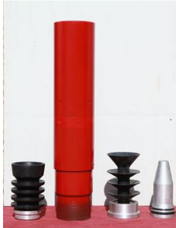
Εικόνα 2.1.1.8: Multi-Stage Collar. Στην φωτογραφία διακρίνεται το τμήμα της σωλήνωσης με τα δύο εξαρτήματα που τοποθετούνται στο εσωτερικό του, καθώς και η σφήνα. (Σταματάκη, 2017)
