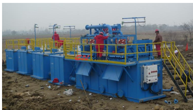
Εικόνα 2.3.1: Μονάδα παρασκευής τσιμεντοπολφού. ( www.gnsolidscontrol.com )
