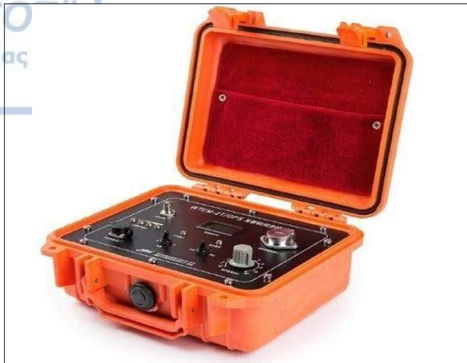
Σχήμα 5.7 Η μονάδα ελέγχου συγχρονισμού GPS του δέκτη (BTSK Geophysical Instruments).
