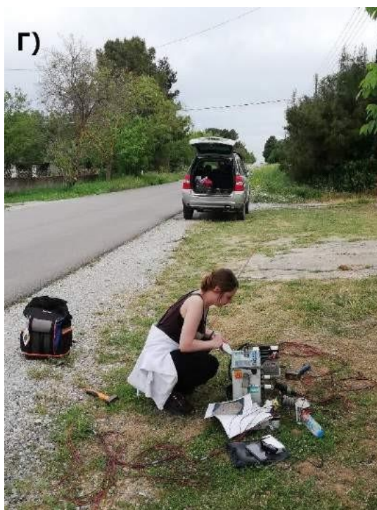
Σχήμα 4.8 A), B) Ανάπτυγμα πολυκάναλων ηλεκτροδίων για τη μέθοδο της ηλεκτρικής τομογραφίας, Γ) Ορισμός των παραμέτρων της μέτρησης, Δ) Μεταφορά των δεδομένων των μετρήσεων σε ηλεκτρονικό υπολογιστή.
