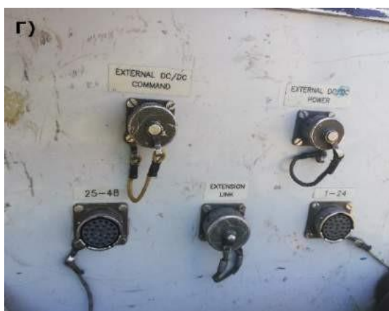
Σχήμα 4.7 A) Το όργανο Syscal Pro της IRIS Instruments, B) Το όργανο Syscal Pro συνδεδεμένο με εξωτερική μπαταρία και με πολύκλιωνα καλώδια που περιέχουν τα ηλεκτρόδια, Γ) Πίσω όψη του οργάνου, όπου συνδέονται τα 48 ηλεκτρόδια.
