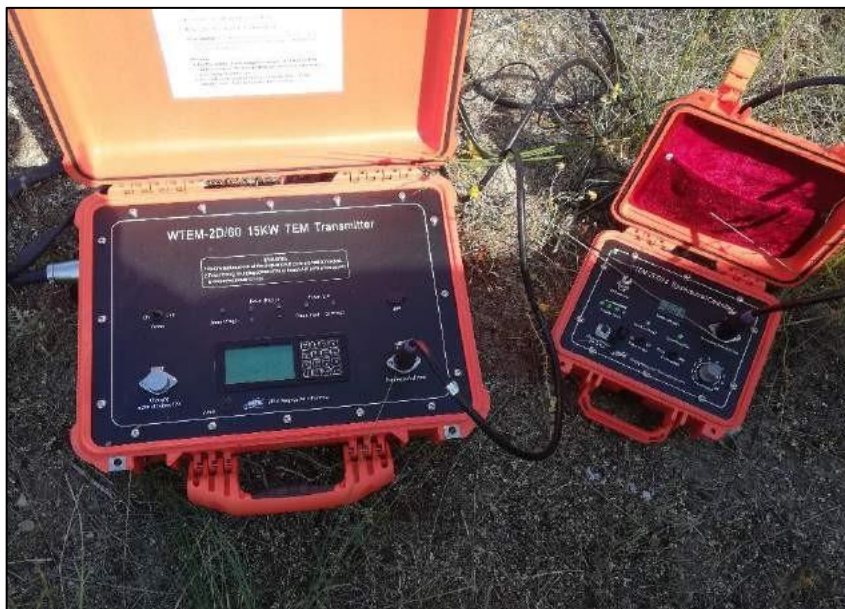
Σχήμα 5.8 Σύνδεση του πομπού με τη μονάδα συγχρονισμού του GPS.
