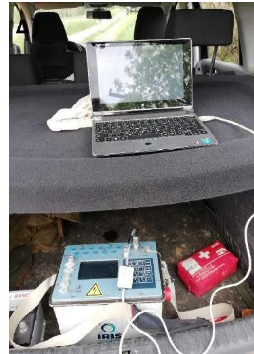
Σχήμα 4.8 A), B) Ανάπτυγμα πολυκάναλων ηλεκτροδίων για τη μέθοδο της ηλεκτρικής τομογραφίας, Γ) Ορισμός των παραμέτρων της μέτρησης, Δ) Μεταφορά των δεδομένων των μετρήσεων σε ηλεκτρονικό υπολογιστή.
