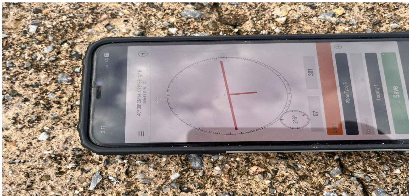
Εικόνα 19 Κλίση της στέψης 6^{\circ} και διεύθυνση κλισης 301^{\circ} ΒΔ
