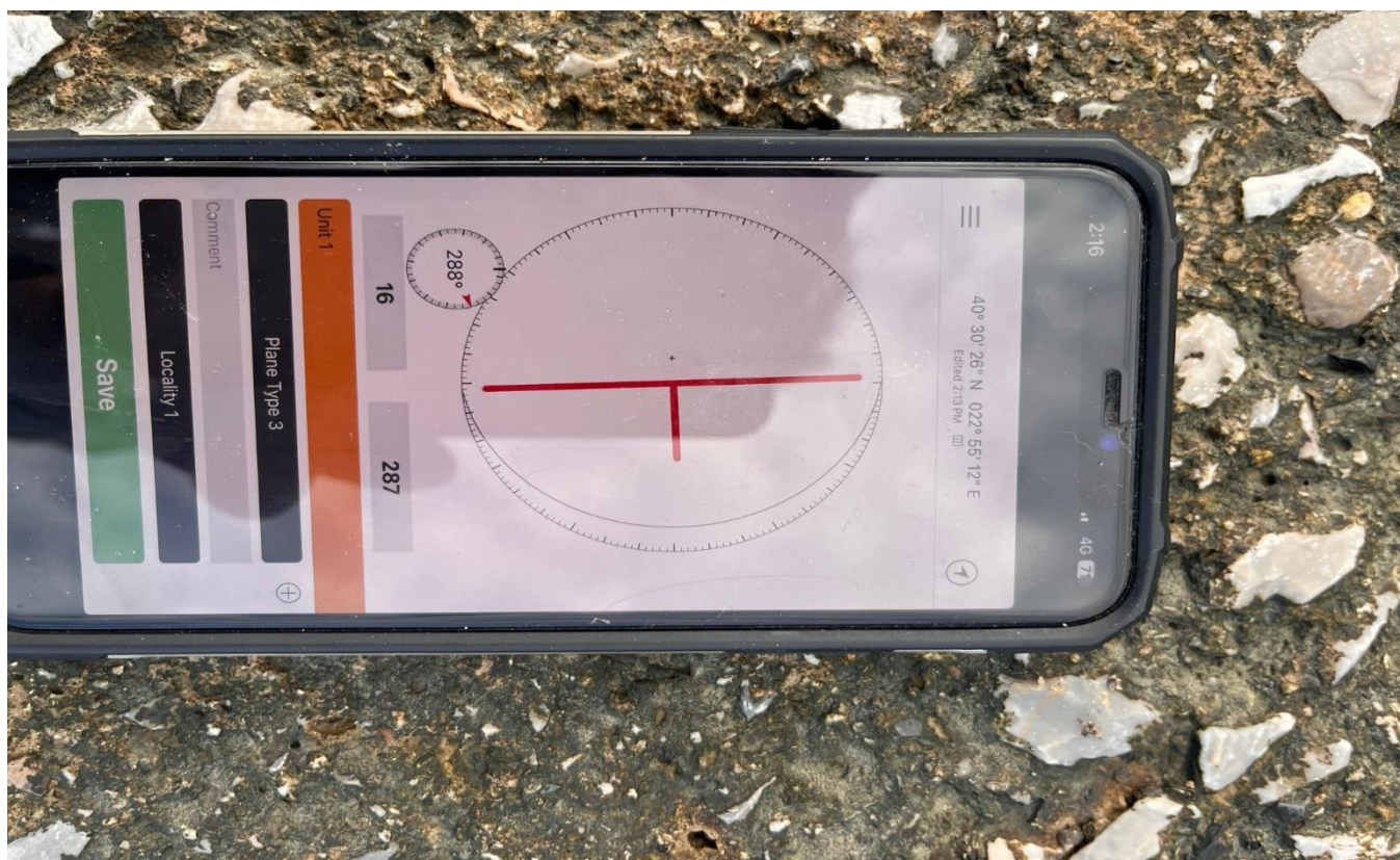
Εικόνα 23 Κλίση 16^{\circ} και διεύθυνση κλίσης 287^{\circ} ΒΔ
