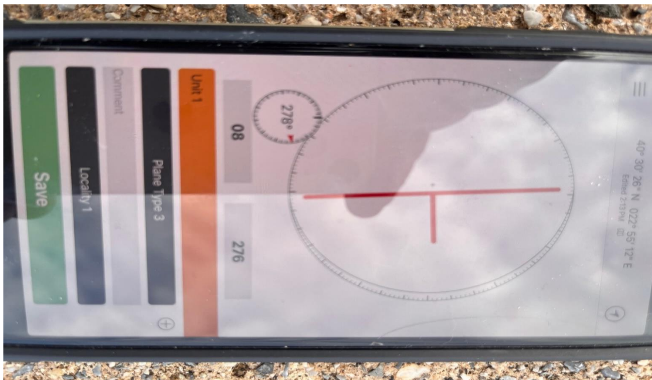
Εικόνα 20 Κλίση 8^{\circ} και Διεύθυνση κλισης 278^{\circ} ΒΔ
