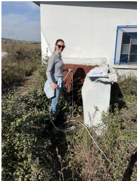
Σχήμα 5.2 και Σχήμα 5.3: Μέτρηση μεταβολής σε βάθος της θερμοκρασίας και της ηλεκτρικής αγωγιμότητας του υπόγειου νερού στη γεώτρηση Βλάχος 1 τον Οκτώβριο του 2023.
