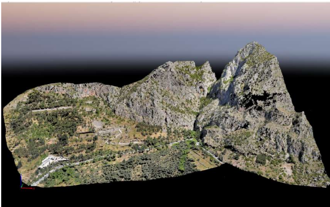
Εικ. 54. Τρισδιάστατο ρεαλιστικό μοντέλο (3D Mesh model) της υπό έρευνα περιοχής, από την εναέρια αποτύπωση με UAV (Unmanned Aerial Vehicles), σε περιβάλλον Pix4Dmapper.
