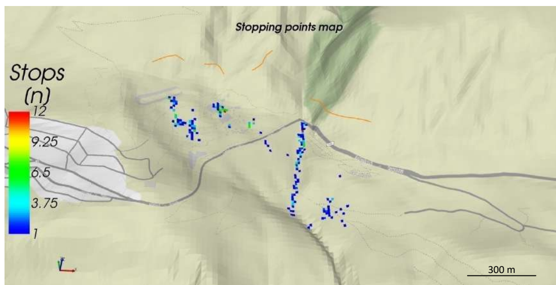
Εικ. 77. Τρισδιάστατη χωρική απεικόνιση των σημείων τερματισμού των τροχιών στον Αρχαιολογικό Χώρο των Δελφών, με σεισμικές συνθήκες ( PGV=0,41 m/sec). Στην πάνω εικόνα απεικονίζεται η χωρική κατανομή των σημείων τερματισμού των μπλοκ, με μέση διάμετρο βραχωδών τεμαχών ( d ) ίση με 1m και στην κάτω εικόνα με μέση διάμετρο ίση με 1,3m, 1,5m, 1,3m και 1,5m για τις 4 ζώνες εκκίνησης πιθανής βραχοκατάπτωσης.
