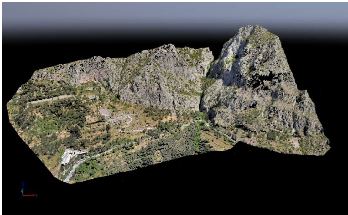
Εικ. 67. Τρισδιάστατο ρεαλιστικό μοντέλο (3D Mesh model) της περιοχής έρευνας από την εναέρια αποτύπωση με UAV (Unmanned Aerial Vehicles), σε περιβάλλον Pix4Dmapper.
