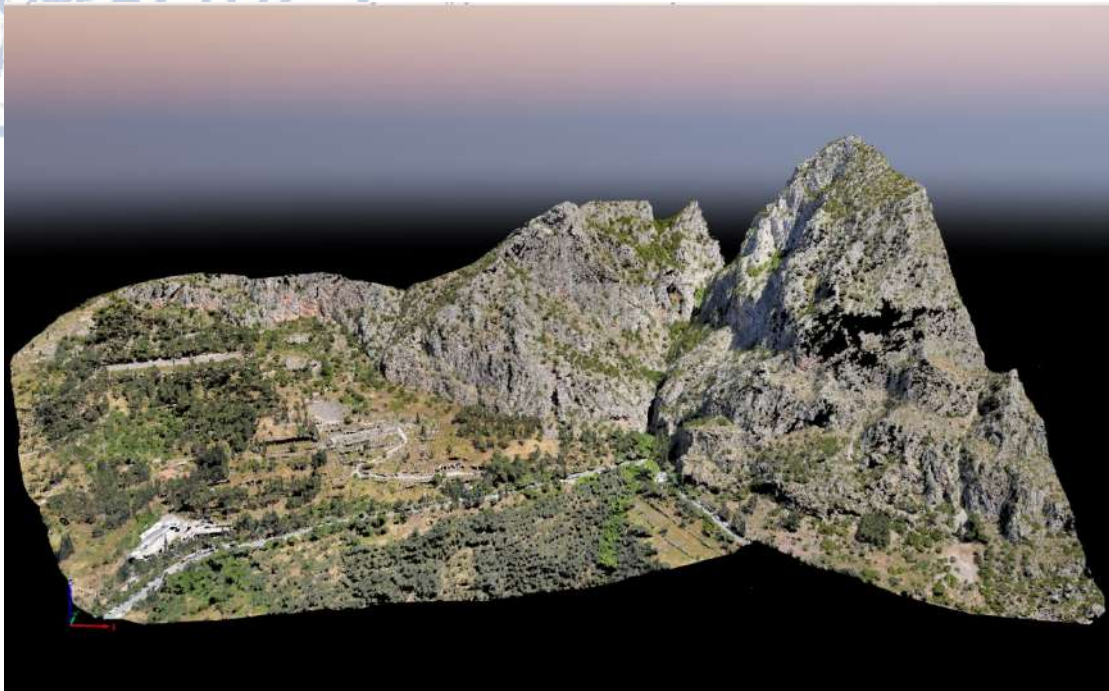
Εικ. 10. Τρισδιάστατο μοντέλο απεικόνισης του Αρχαιολογικού Χώρου των Δελφών, όπως δημιουργήθηκε με τη χρήση του λογισμικού Pix4Dmapper, από λήψη με UAV (Unmanned Aerial Vehicles). Παρατηρούνται τα πολύ μεγάλης κλίσης, ασβεστολιθικά πρανή, ανάντη του Χώρου, όπου περιλαμβάνεται το σύνολο των μνημείων.
