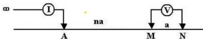
Σχήμα 5: Θέσεις ηλεκτροδίων με την διάταξη Πόλου- Διπόλου
