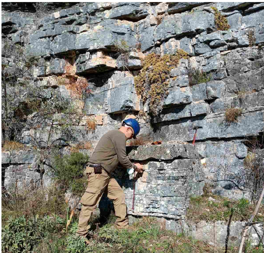
Εικόνα 23: Λήψη μετρήσεων ασυνεχειών επί του μελετώμενου πρανούς, με γεωλογική πυξίδα τύπου clark.
