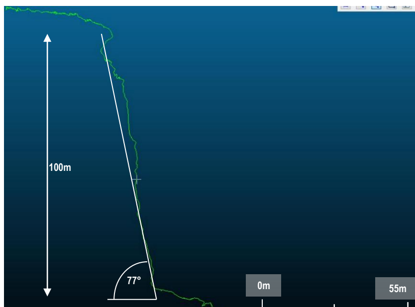
Σχήμα 32: Τομή επί του ασβεστολιθικού πρανούς, κάθετη στη κλίση διεύθυνσης του φυσικού πρανούς ύψους περί τα 100m.
