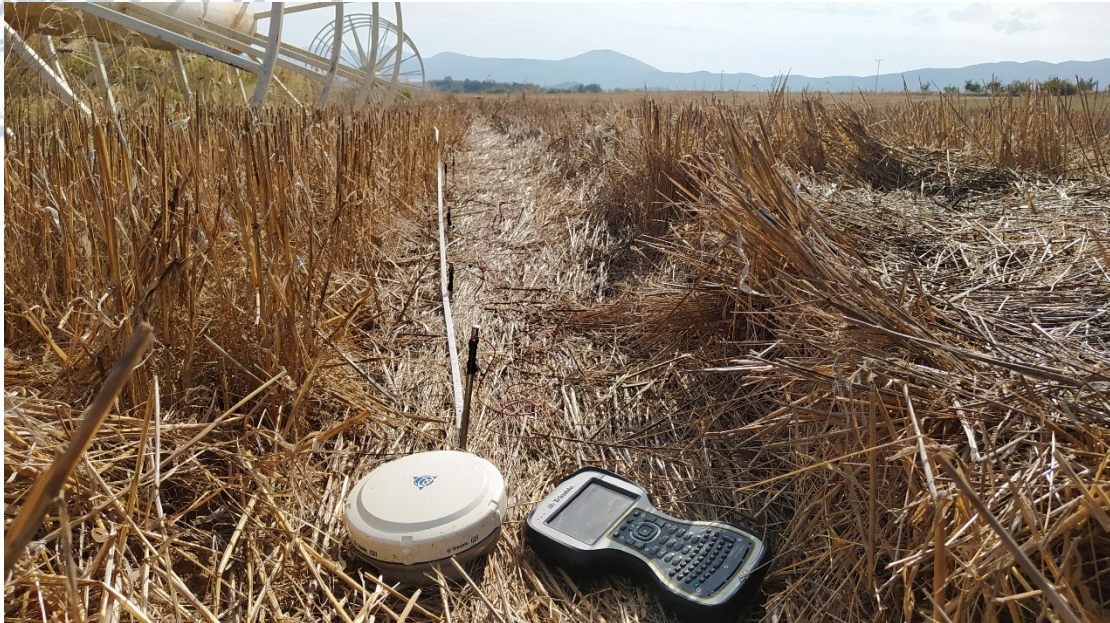
Εικόνα 19: Αριστερά φαίνεται το διαφορικό GPS και δεξιά φαίνεται το όργανο καταγραφής των δεδομένων που συλλέγει το GPS. Από προσωπικό αρχείο.
