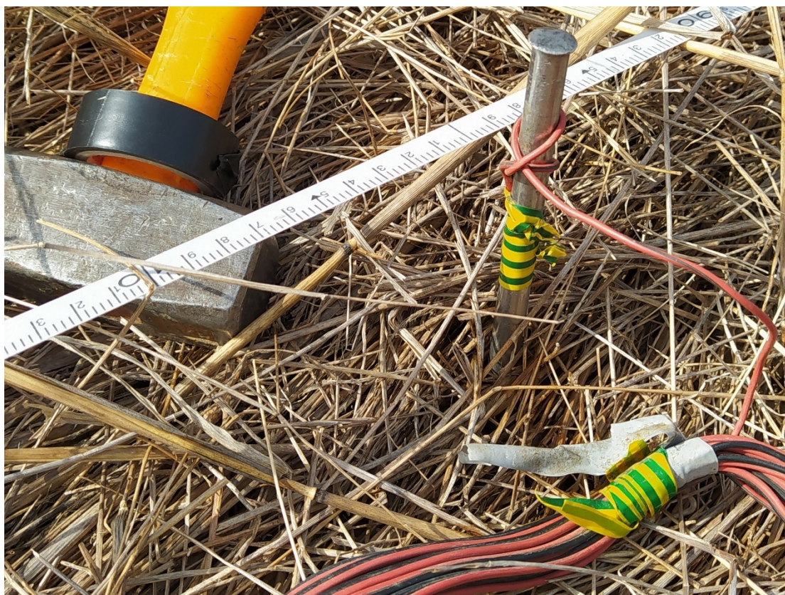
Εικόνα 17: Ηλεκτρόδιο καρφωμένο στο έδαφος με την καθοδήγηση της μετροταινίας, ώστε να έχουν ίσες αποστάσεις μεταξύ τους, από προσωπικό αρχείο.
