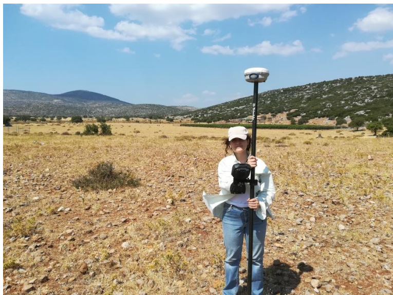
Εικόνα 9 : Φωτογραφία μου στο πεδίο με το GPS ακριβείας καθώς καταγράφω τις θέσεις των τελευταίων ηλεκτροδίων της δεύτερης τομογραφίας (ERT2).
