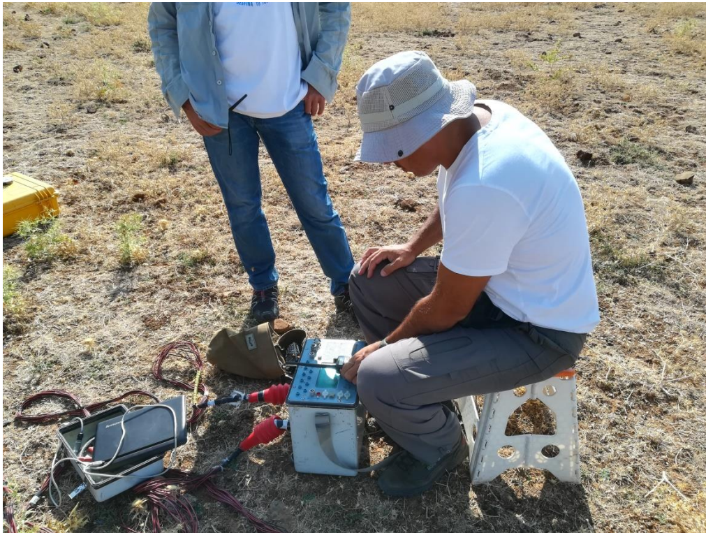
Εικόνα 3 : Φωτογραφικό υλικό από την θέση Καστρούλι, Δεσφίνας. Οι Δρ. Φίκος Ηλίας και Σταμπολίδης Αλέξανδρος με το όργανο μέτρησης επιβλέπουν τα αποτελέσματα που δίνονται από τον μετρητή αντίστασης.
