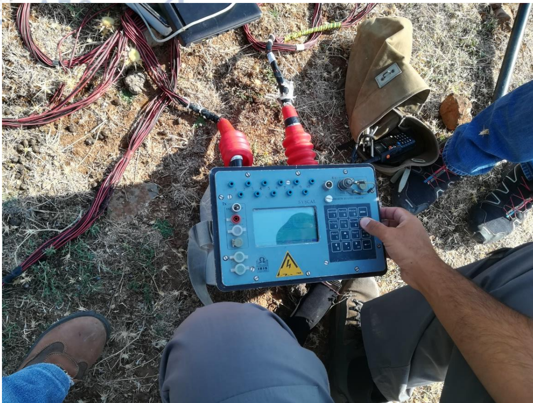
Εικόνα 7 : Έλεγχος λειτουργίας του καταγραφέα και προσδιορισμός του χρόνου ολοκλήρωσης των μετρήσεων.
