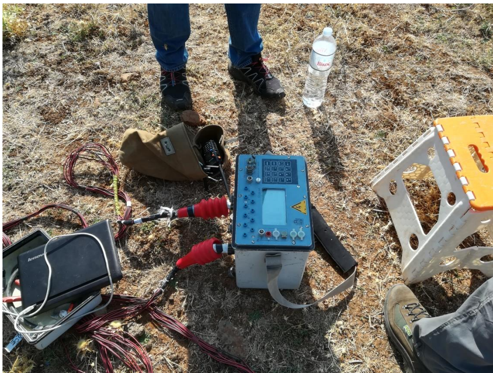
Εικόνα 5 : Πλήρες σύστημα εκτέλεσης γεωηλεκτρικής τομογραφίας 48 καναλιών και δωδεκάβολτη μπαταρία.
