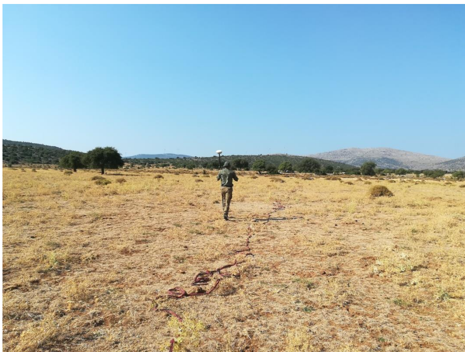
Εικόνα 4 : Φωτογραφικό υλικό από την θέση Καστρούλι, Δεσφίνας. Στο κέντρο της εικόνας διακρίνεται μια σειρά από ηλεκτρόδια τοποθετημένα στην επιφάνεια του εδάφους και μέσω ενός πολυκάναλου καλωδίου λαμβάνονται αυτόματα οι μετρήσεις.
