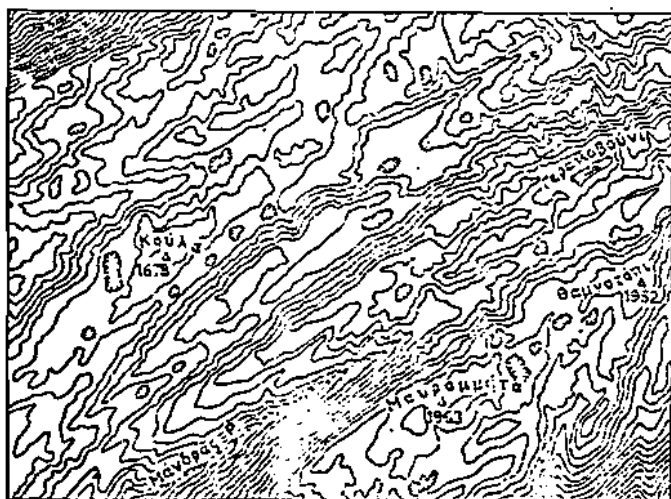
Εχ. 1. Τμήμα του τοπογραφικού χάρτη Σερρών κλίμακας 1:50.000, με χαρακτηριστικές ισοϋψείς καταπτώσεως (ισοδιάσταση 20 m).
