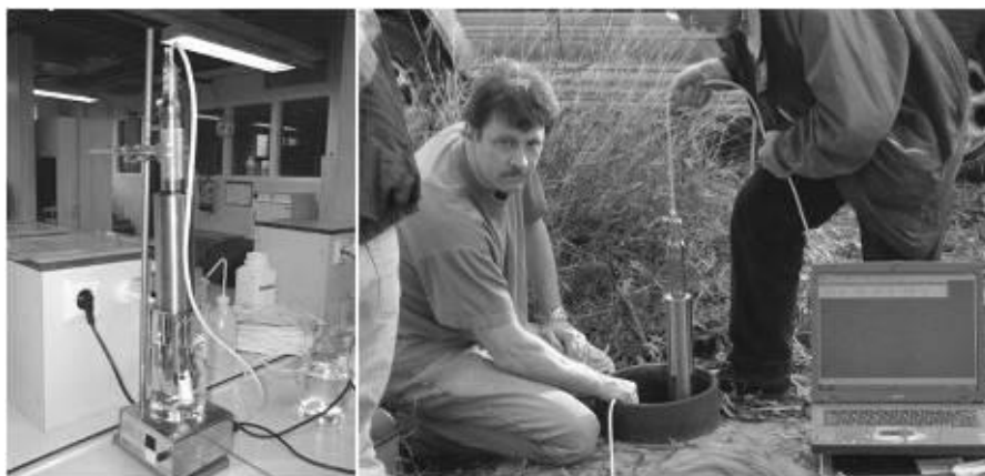
Εικόνα 1. Αριστερά: Ο φωρατής, με προσαρτημένα ISE κατά την διάρκεια βαθμονόμησης με πρότυπα διαλύματα. Δεξιά: Ο φωρατής εισαγόμενος σε φρεάτιο γεωτρήσεως. Στην παρούσα περίπτωση το σύστημα έχει διαμορφωθεί για μετρήσεις μίας θέσης και μαζί με τον φωρατή αποτελείται από μία καταγραφική μονάδα και ένα Η/Υ (φορητό ή χειρός), για έλεγχο της διαδικασίας μετρήσεων και αποθήκευσης των δεδομένων.
