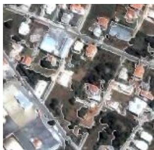
Εικόνα 6. Ακμές που έχουν ανιχνευτεί επί RGB εικόνας
