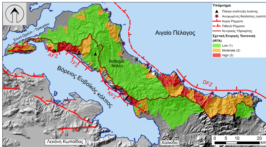
Εικόνα10. Χωρική κατανομή των τιμών του δείκτη IRTA. Το ανάγλυφο κατηγοριοποιείται σε 3 τάξεις με βάση το βαθμό διαμόρφωσης των χαρακτηριστικών του από την τεκτονική δραστηριότητα. (DFZ: Ρηξιγενής ζώνη Διρφύος, KFZ: Ρηξιγενής ζώνη Κανδηλίου, TFZ: Ρηξιγενής ζώνη Τελέθριου, AFZ: Ρηξιγενής ζώνη Αιδηψού). Στο χάρτη σημειώνονται οι θέσεις των ανυψωμένων θαλάσσιων εγκοπών (Stiros et al. 1992).
