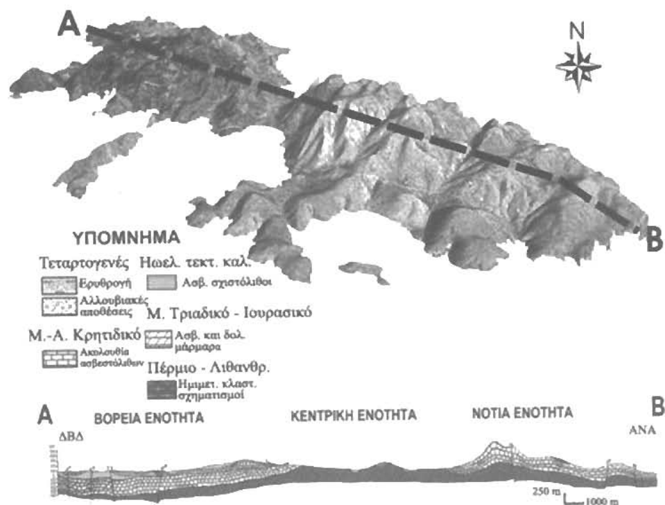
Σχήμα 2: Τρισδιάστατη απεικόνιση της Σκύρου που προήλθε από την υπέρθεση της ψευδοχρωματικής εικόνας Landsat 7/ETM+, πάνω στο ψηφιακό μοντέλο αναγλύφου (Αζιμουθίο 180°, ψηφιακή Βιβλιοθήκη "Θεόφραστος" - Τμήμα Γεωλογίας, Α.Π.Θ. σε 25Km) και γεωλογική τομή ΑΒ, διεύθυνσης ΔΒΔ-ΑΝΑ.
