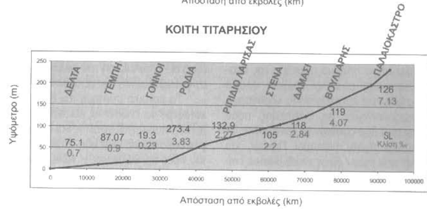
Σχήμα 4. Οι επιμήκεις μορφολογικές τομές των κοιτών Πηνειού και Τιταρήσιου, οι τιμές του μορφολογικού δείκτη SL (stream length) και των κλίσεων για τα διάφορα τμήματα των κοιτών των ποταμών από την εκβολή τους και προς τα ανάντη.
