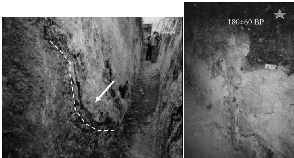
Σχήμα 8. Αριστερά: Επιφάνεια ολίσθησης παλαιοκατολίσθησης σε αργιλο-μαργαϊκά στρώματα (Τομή 1Α). Δεξιά: Μικροδιαρρήξεις και διαταραγμένα στρώματα (Τομή 1Α).
