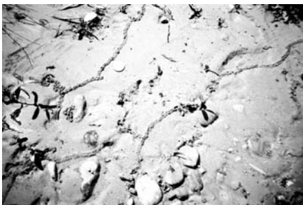
Σχήμα 9α. Βασιλική: Εδαφικές διαρρήξεις με ανάδυση λεπτόκοκκου υλικού
