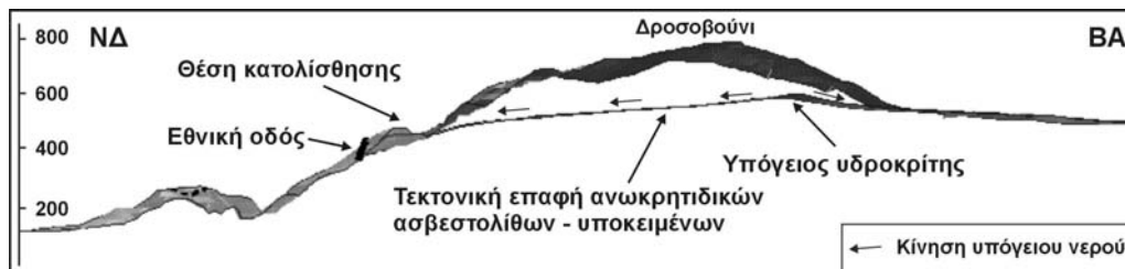
Σχήμα 11. Η γεωλογική τομή A-B στην οποία φαίνονται το ανάγλυφο και η τεκτονική επαφή των ανωκρητιδικών ασβεστόλιθων με τους υποκείμενους σχηματισμούς. Η θέση της τομής φαίνεται στο Σχήμα 10.
