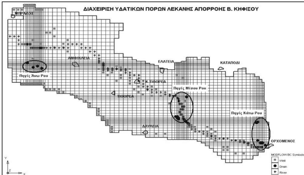
Σχήμα 2. Κάναβος μαθηματικού ομοιώματος και οριακές συνθήκες. Με ελλείψεις σημειώνονται οι ζώνες ανάπτυξης των καρστικών πηγών.
