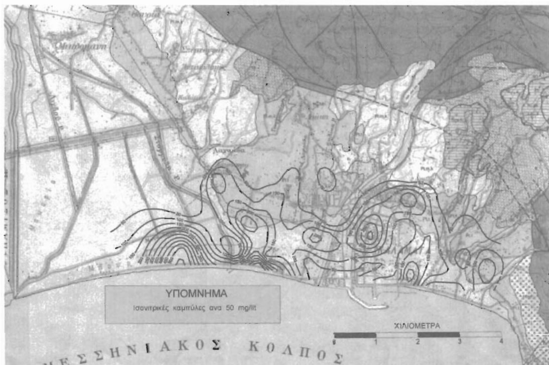
Σχ. 4 Χάρτης ίσoανιτρικών καμπύλων περιόδου Σεπτεμβρίου 1995 Fig. 4 Map of equal nitrate's lines (period: September 1995)
