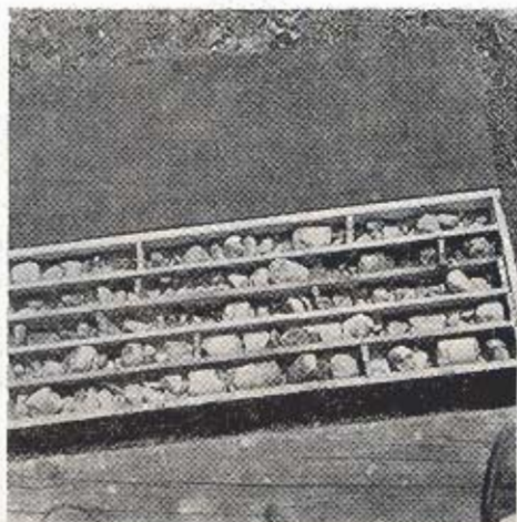
Σχ. 3. Ασβεστολιθικοί πυρήνες από την γεώτρηση Γ2, βάθους 15,40 μ. Έμφανής είναι ο ισχυρός κερματισμός του πετρώματος.
