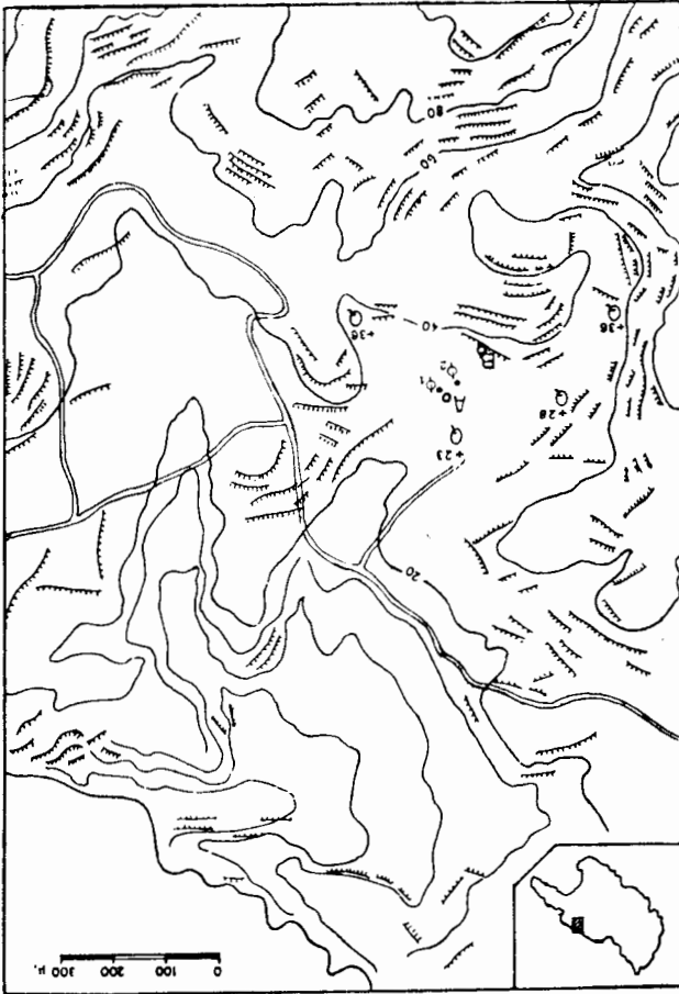
Εἰκ. 1. Τοπογραφικὸς χάρτης 1 : 10.000 τῆς περιοχῆς Κεφαλοβρύσου. Σμίκρυνσις ἐκ τοῦ φύλλου Ζακύνθου 1 : 5.000. Q — θήσεις πηγῶν, Φ 1 — Φ 2 φρέατα, Α — Β γεωτρήσεις.
