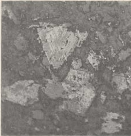
Abb. 19: Orientierte Martitlamellen in ehemaligem Magnetit. (001) Fläche des Hämatits // (111) des ehem. Magnetits. Anschl. halbgekreuzte Nicols. \times 250 .
