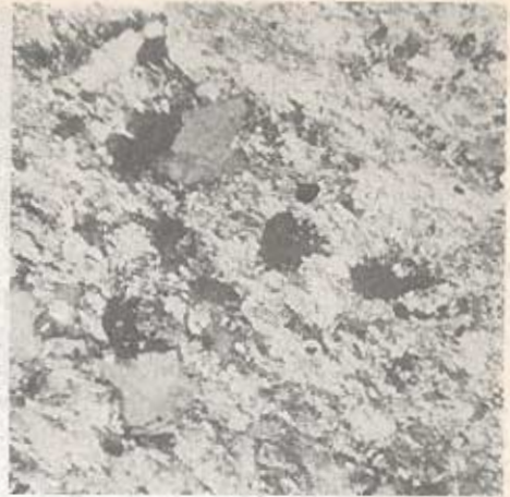
Abb. 20: Quarzkörner werden von Talk korrodiert. Talkschiefer, Dünnschliff + Nicols. \times 250 .
