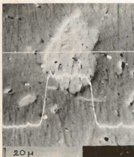
Abb. 14: Linienseannings quer durch den Milleriteinschluß im Magnetit: 14a von FeKa, 14b von NiKa, 14c von SKa.
