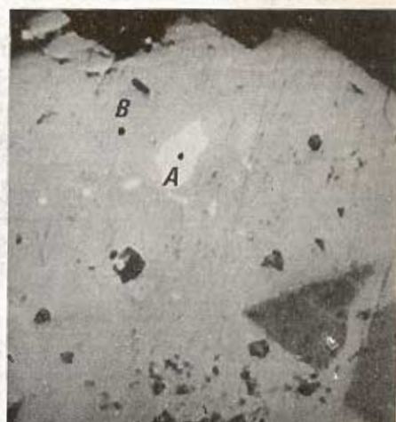
Abb. 12: Tropfenförmige Milleriteinschlüsse im Magnetit. Anschl. // Nic. \times 250 .
