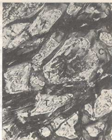
Abb. 4: Talk - und Antigoritneubildung im Serpentin. C = Chrysotil, T = Talk, A = Antigorit. Dünnschliff + Nicols. \times 250 .
