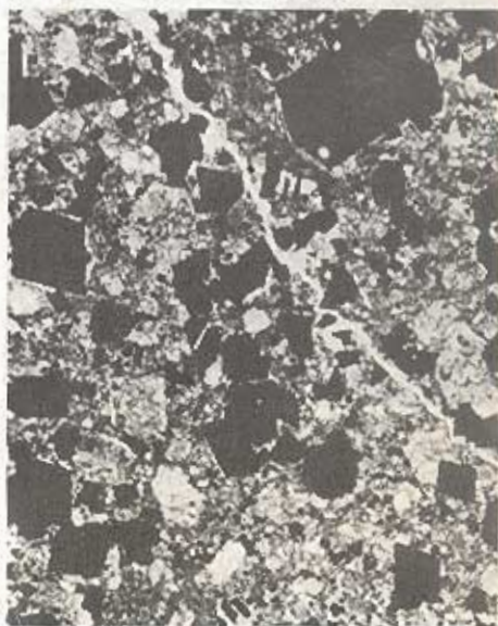
Abb. 8: Magnetitblasten, meist mit Chromitkern (halbdurchsichtiger Kern im Magnetit) in einer feinkristallinen phyllosilikatischen Masse. Dünnschliff // Nicols, \times 100 .
