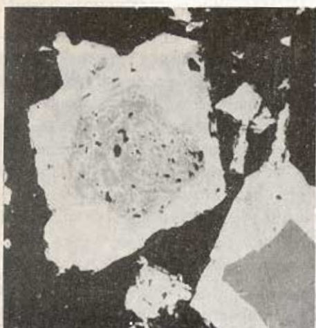
Abb. 11: Verdrängung eines Chromits von Magnetitidioblasten. Erklärung im Text. Anschl. // Nic. \times 250 .
