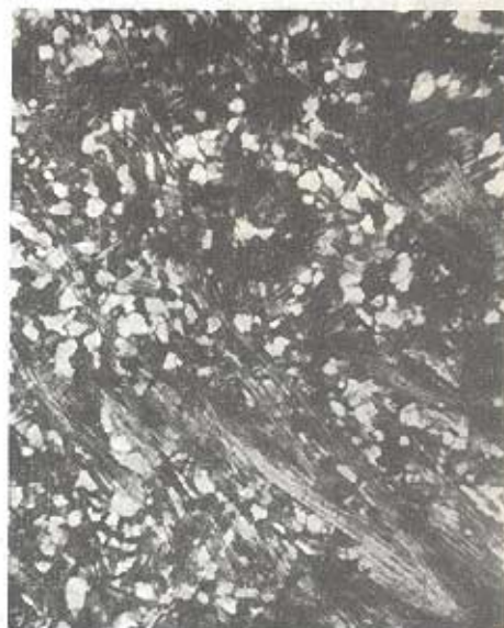
Abb. 6: Metapseudohornstein“ (Quarzit) mit feinkörnigem granoblastischem Quarzgefüge und Riebeckitnematoblasten. Dünnschliff // Nicols, \times 100 .
